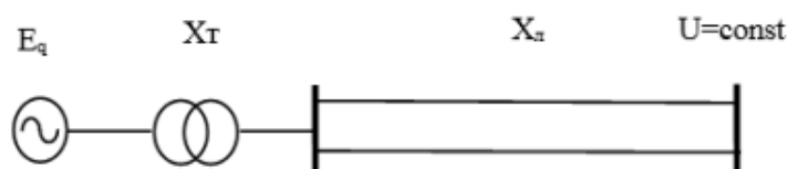
3-rasm Oddiy elektr tizimning prinsipial sxemasi
