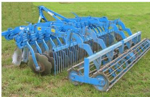
2-rasm. AG-1,8-20 diskli kombinatsiyalashgan agregat
