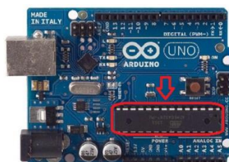
4-rasm. Arduino UNO mikrokontrollerining tashqi ko'rinishi.
