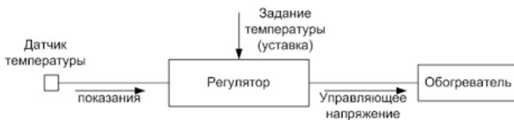
Рис. 1.5 Под капотом у ПИД регулятора
