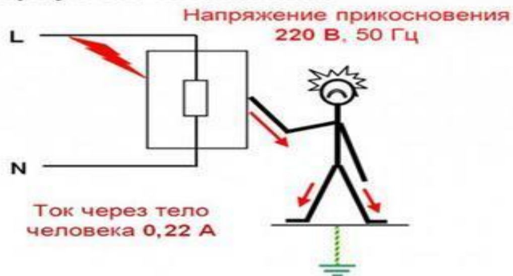
Корпус без заземления
