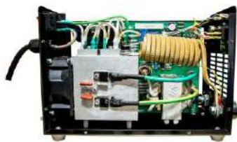
Рис.2. Конструкция силовой части инвертора
