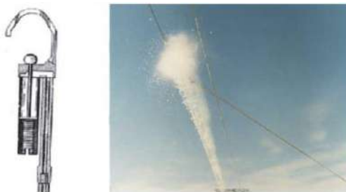
Рис. 2. Пневматическое устройство для механического удаления льда с провода
