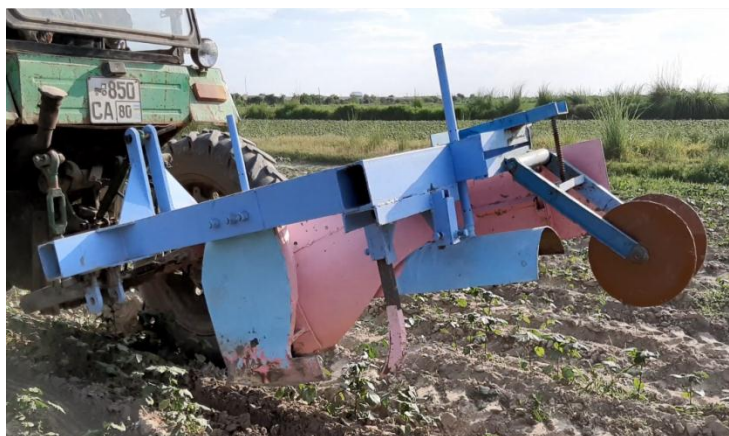
2-расм. Зичловчи қурилма билан жиҳозланган пол ҳосил қилиш қурилмасининг тажриба синов нусхаси
