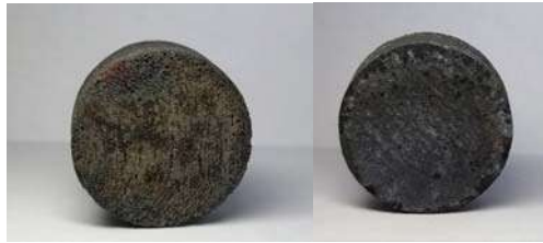
Рисунок 2. Пример опытных образцов после проведения СВС
