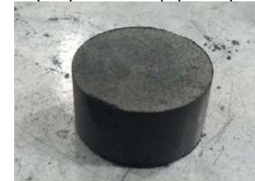
Рисунок 1. Спрессованный в брикет опытный образец до сжигания в СВС реакторе
