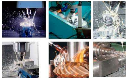
Рисунок 1 - Подача СОЖ поливом и напорной струей при обработке на различных металлорежущих станках
