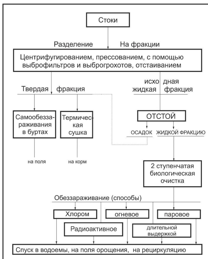
Рис.1 Схема переработки, очистки, обеззараживания и использования ЖИВОТНОВОДЧЕСКИХ стоков.
