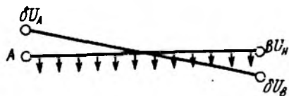
Рис. 5.30. Схема линии с распределенной нагрузкой и отклонениями напряжения в ней
