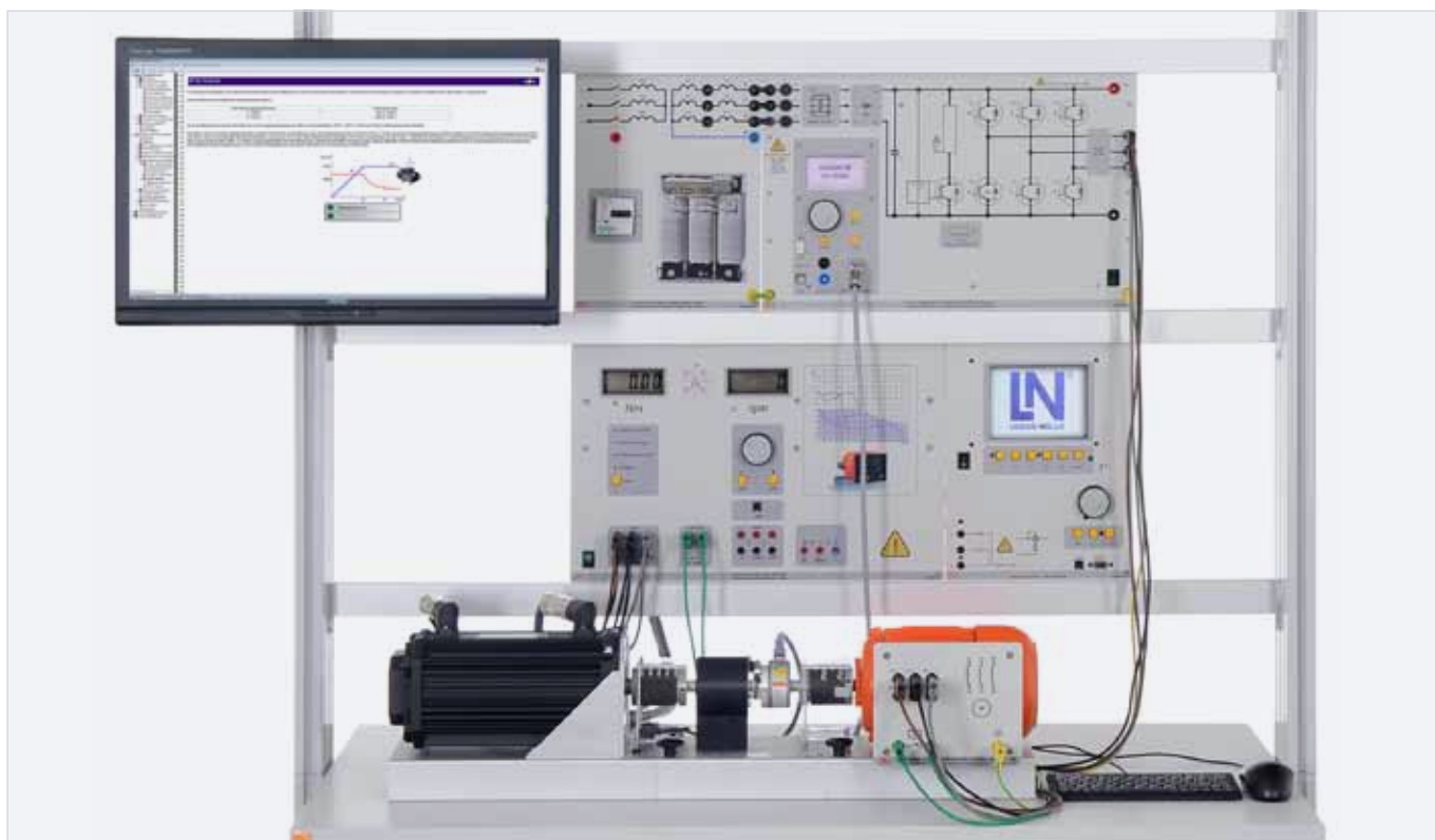
Тренажерная система «Ориентированное по полю регулирование возбуждения асинхронных электродвигателей при помощи языка программирования Matlab®/Simulink® и испытательного стенда для сервомеханизмов»
