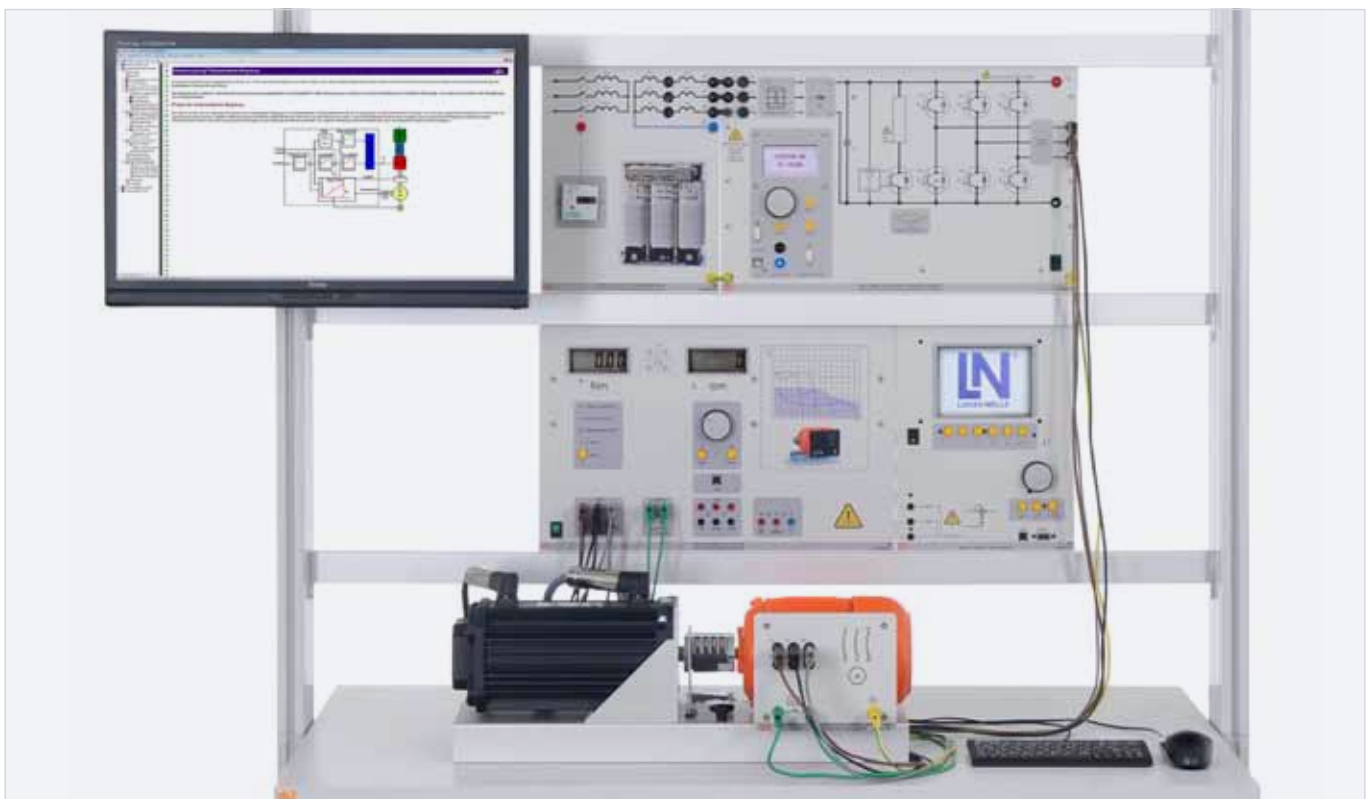
Тренажерная система «Электропривод с питанием от вентильного преобразователя частоты с испытательным стендом для сервомеханизмов»
