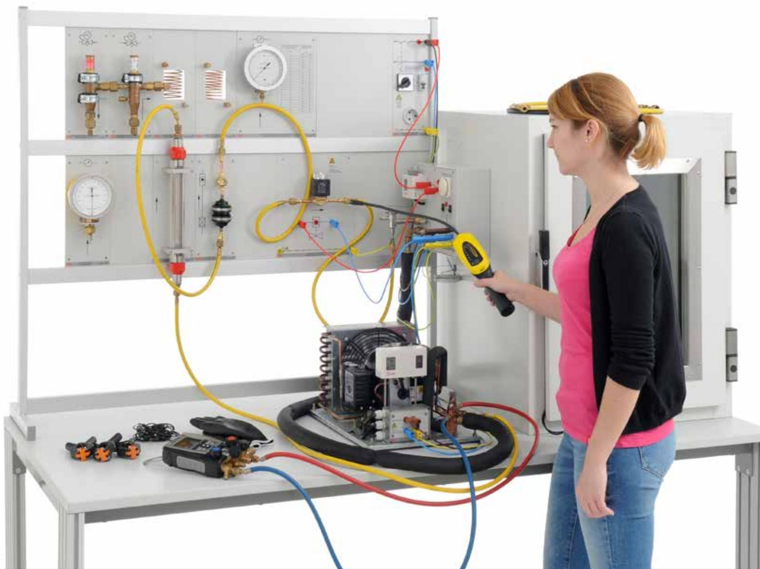
Отображение сложных процессов простой холодильной установки наглядными средствами: мастерски выполненные анимационные изображения и подробные инструкции демонстрируют работу реального цикла с перспективным хладагентом **R290** (пропан) – натуральным хладагентом с низким потенциалом влияния на глобальное потепление (GWP). Большое преимущество: в отличие от многих других хладагентов, он не подлежит поэтапному выводу из эксплуатации («Phase Down»).
