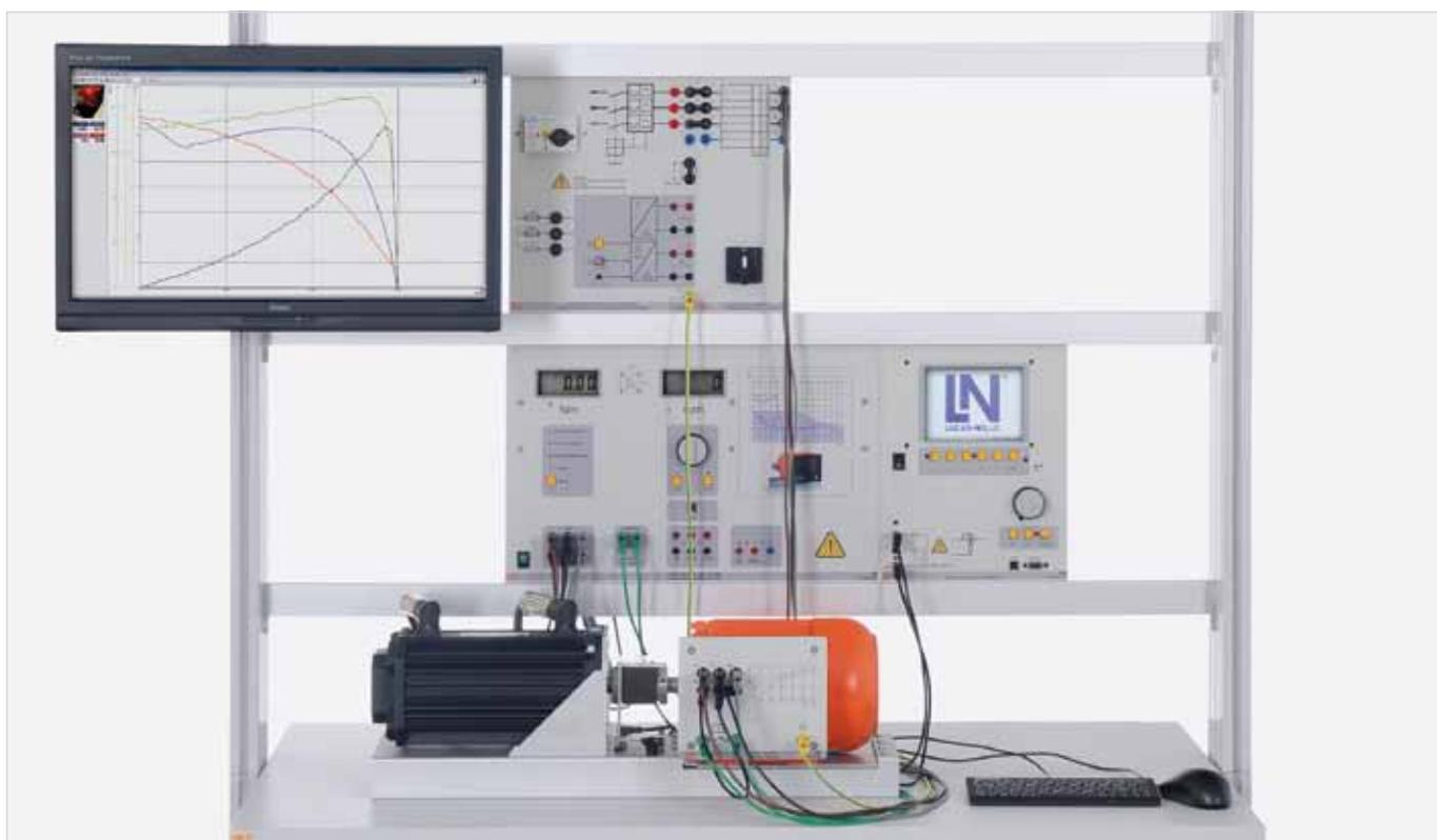
Тренажерная система „Энергоэффективный двигатель“, состоящая из высокоэффективного двигателя и испытательного сервостенда
