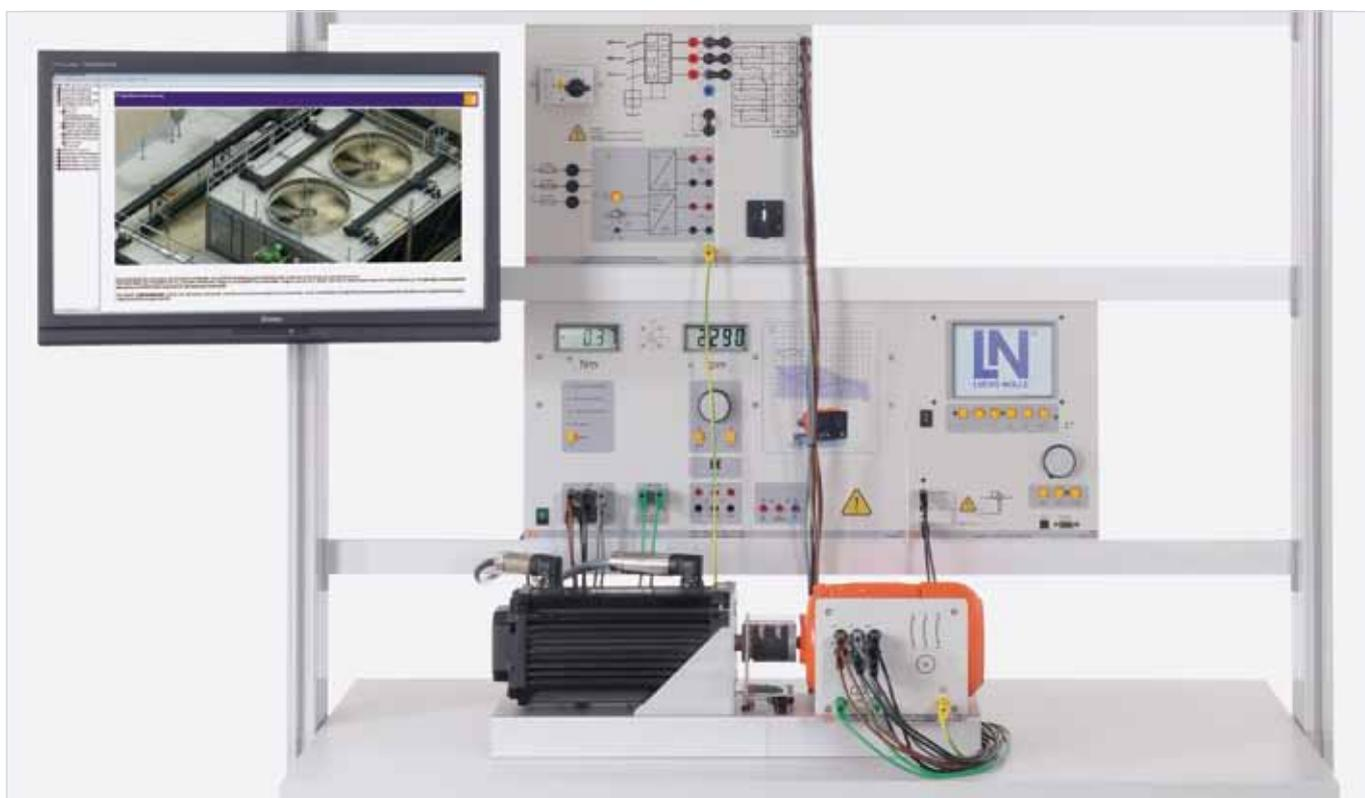
Тренажерная система „Расчет энергоэффективных приводов“, состоящая из трехфазного асинхронного двигателя и испытательного сервостанда
