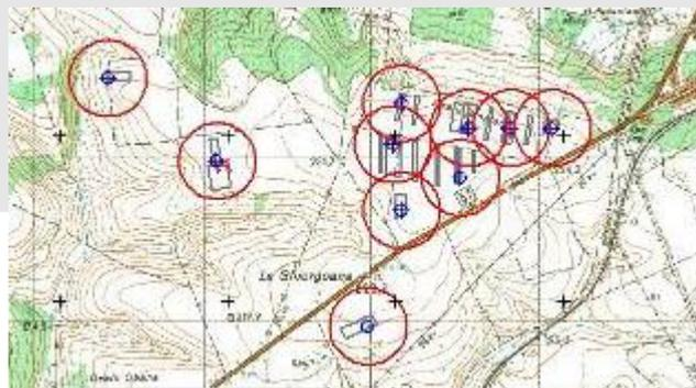
Для предотвращения турбин от взаимных помех (турбулентность) минимальная дистанция в 8 роторных диаметров в основном и 5 роторных диаметров должна быть сохранена. Следовательно, зона в **10 га** ( = 0.1 км<sup>2</sup>) требуется для каждой турбины
