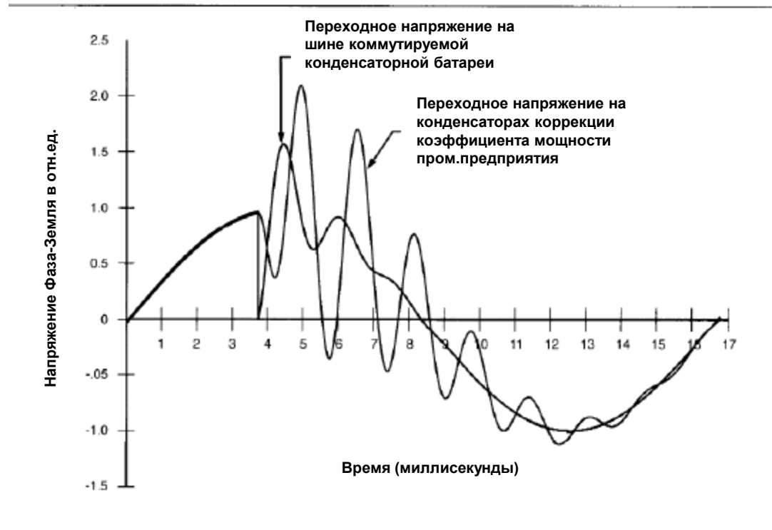
Рис.3. Усиление напряжения на конденсаторах для коррекции коэффициента мощности промышленного предприятия в процессе коммутации конденсаторной батареи на сетевой подстанции
