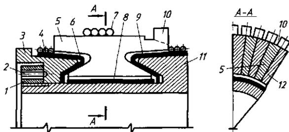
Рис. 9.12. Коллектор на стальной втулке:
