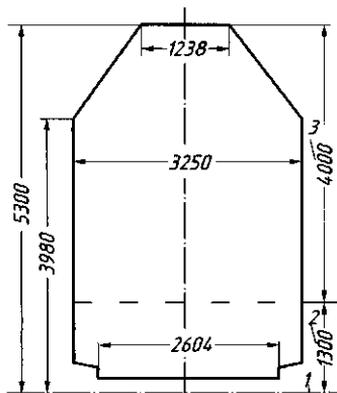
Рис. 3.27. Железнодорожный габарит №1В  $\frac{ОСТ}{ВКС} 6435$ :
