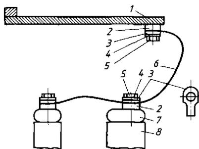
Рис. 11.7. Схема заземления прессующих колец при раздельной прессовке обмоток:
