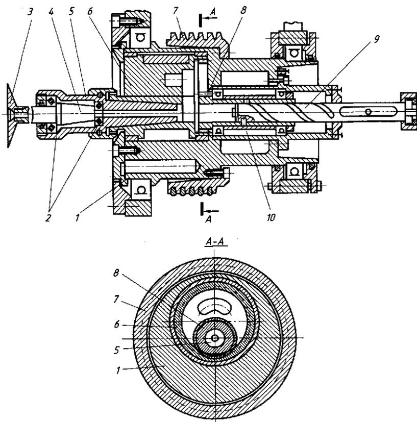
Рис. 8.9. Отрезное устройство станка СО-3М
