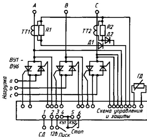
Рис. 14.11. Электрическая схема тиристорного пускателя ПТ40 -380
