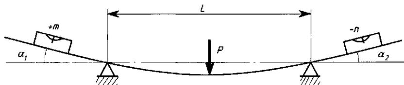
Рис. 3.22. Схема измерения уклонов шеек вала
