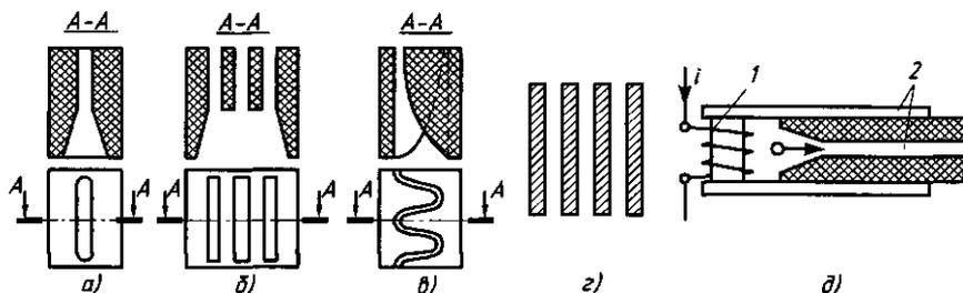
Рис. 4.2. Схемы дугогасительных камер низкого напряжения: а, б, в — щелевые (соответственно с одной щелью, с несколькими параллельными щелями, лабиринтная); г — дугогасительная решетка из металлических пластин; д — с магнитным дутьем и щелевой камерой (1 — электромагнит; 2 — щелевая камера)
