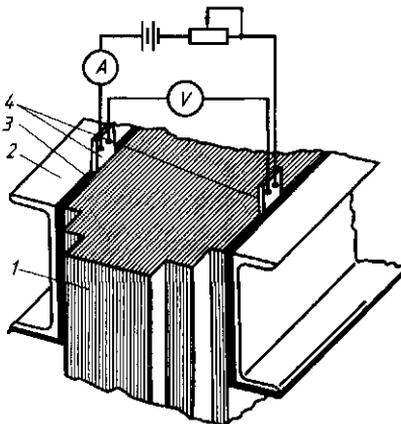
Рис. 3.32. Схема измерения сопротивления изоляции магнитной системы:
