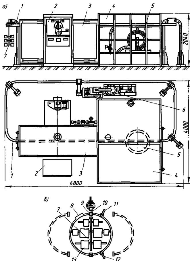
Рис. 10.4. Полуавтоматическая установка АВБ-4 для пропитки под вакуумом и давлением (а) и схема (б) автоклава и подвески:
