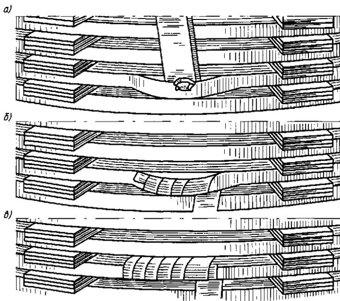
Рис. 11.9. Восстановление поврежденной изоляции витка:
