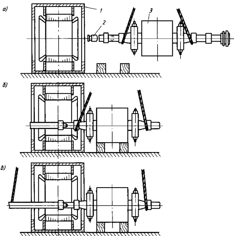
Рис. 3.24. Схема ввода ротора в статор с использованием удлинителя (*а* — начало ввода; *б* — установка ротора на шпалы; *в* — закрепление стропа на удлинителе):
