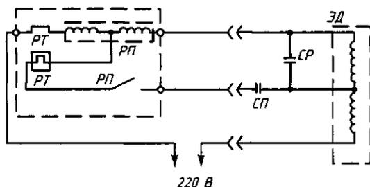
Рис. 5.1. Схема включения электродвигателя с пусковым конденсатором: ЭД — электродвигатель; СП и СР — пусковой и рабочий конденсаторы; РТ — нагреватель и контакт защитного реле; РП — контакт и катушка пускового реле
