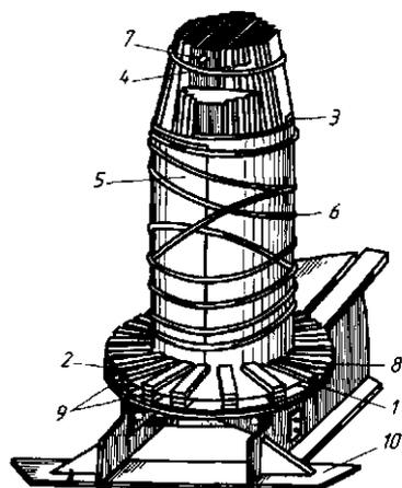
Рис. 12.12. Укладка нижней ярмовой и уравнивающей изоляции: 1 — уравнивающая изоляция; 2 — ярмовая изоляция; 3 — деревянная планка; 4 — ремешок для стяжки верхней части стержня; 5 — цилиндр из электрокартона; 6 — киперная лента для стяжки цилиндра; 7 — отметка места окончания расшивки; 8 — вырез в ярмовой изоляции для прохода концов обмоток; 9 — прокладки ярмовой изоляции из электрокартона; 10 — опорная пластина
