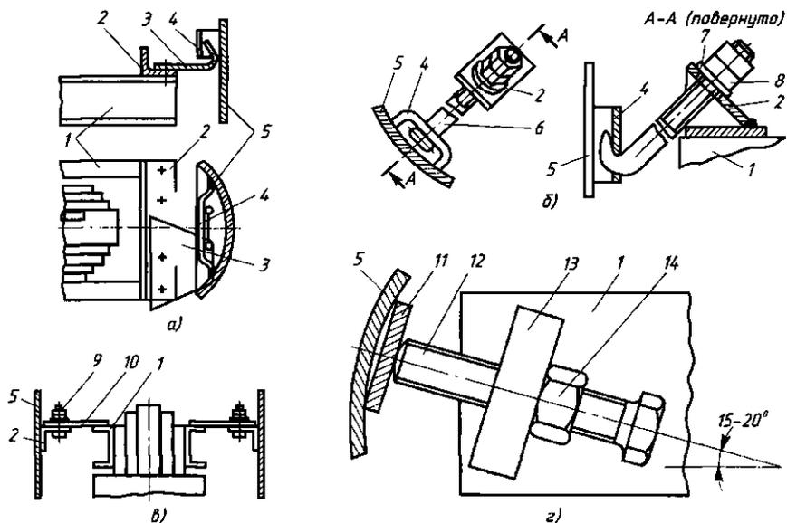
Рис. 11.15. Крепление активной части в баке:
