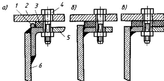
Рис. 11.12. Схема установки прокладки:
