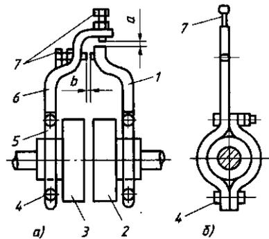
Рис. 3.19. Центровка валов с помощью радиально-осевых скоб:
