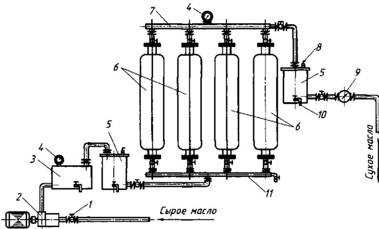
Рис. 12.19. Цеолитовая установка для сушки масла:
