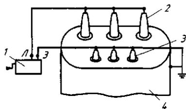
Рис. 12.23. Схема измерения сопротивления изоляции обмоток: 1 — мегаомметр; 2 — вводы ВН; 3 — вводы НН; 4 — бак трансформатора
