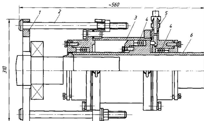
Рис. 8.5. Гидравлический подвесной съемник для снятия подшипников с валов двигателей с высотой оси вращения 180—280 мм (6—9 габаритов):
