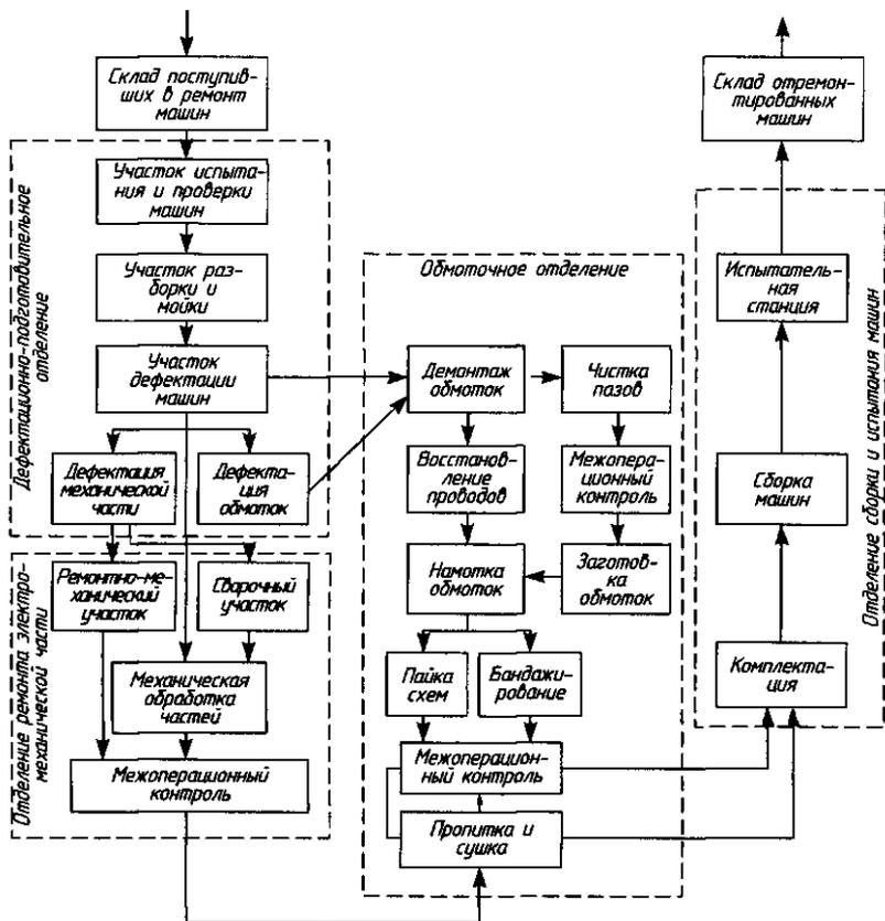
Рис. 7.1. Типовая структурно-технологическая схема ремонта электрических машин
