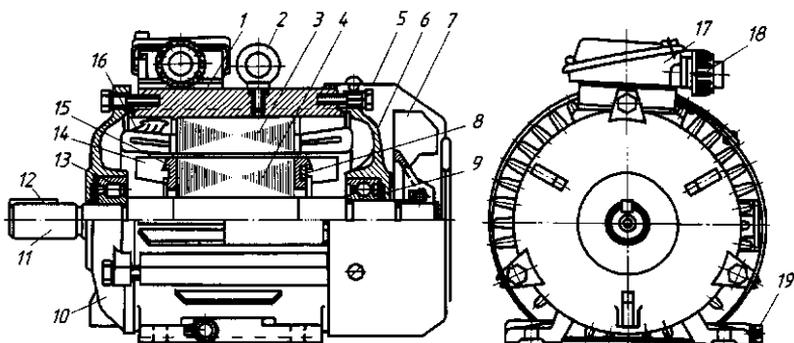
Рис. 1.1. Асинхронный двигатель с короткозамкнутым ротором (степень защиты IP 44, способ охлаждения IC 0141, способ монтажа IM 1001): 1 — станина; 2 — рым-болт; 3 — сердечник статора; 4 — сердечник ротора; 5 — кожух; 6, 10 — подшипниковые шиты; 7 — вентилятор; 8 — балансировочный грузик; 9, 13 — подшипники; 11 — вал ротора; 12 — шпонка; 14 — вентиляционная лопатка; 15 — короткозамыкающее кольцо; 16 — лобовая часть обмотки статора; 17 — коробка выводов; 18 — сальник; 19 — болт
