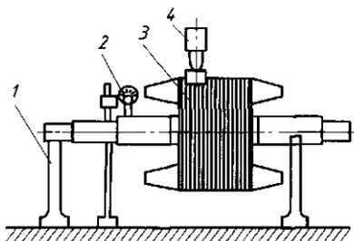
Рис. 9.10. Схема исправления кривизны вала:
