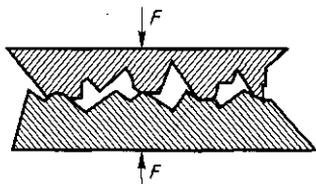
Рис. 13. 8. Соприкосновение поверхностей контактов при наличии сжимающей силы
