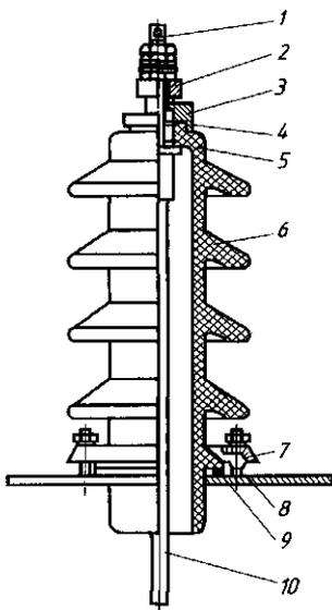
Рис. 11.10. Установка на крышке ввода напряжением 35 кВ:
