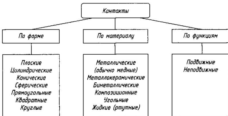
Рис. 13.5. Классификация контактов по форме и материалу
