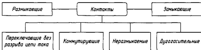
Рис. 13.4. Классификация контактов по назначению
