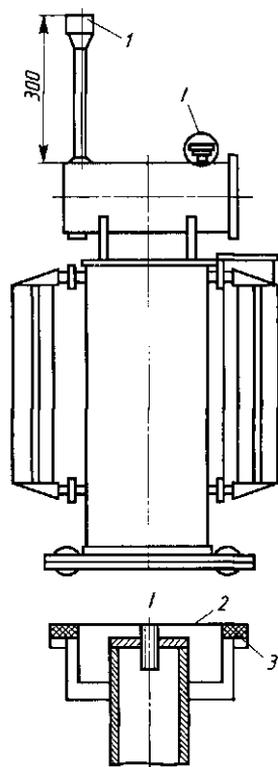
Рис. 11.17. Испытание трансформатора на герметичность:
