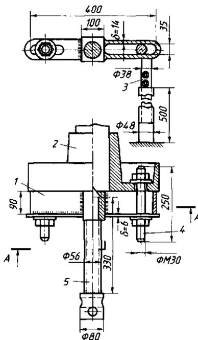
Рис. 8.2. Эскиз съемника с траверсой
