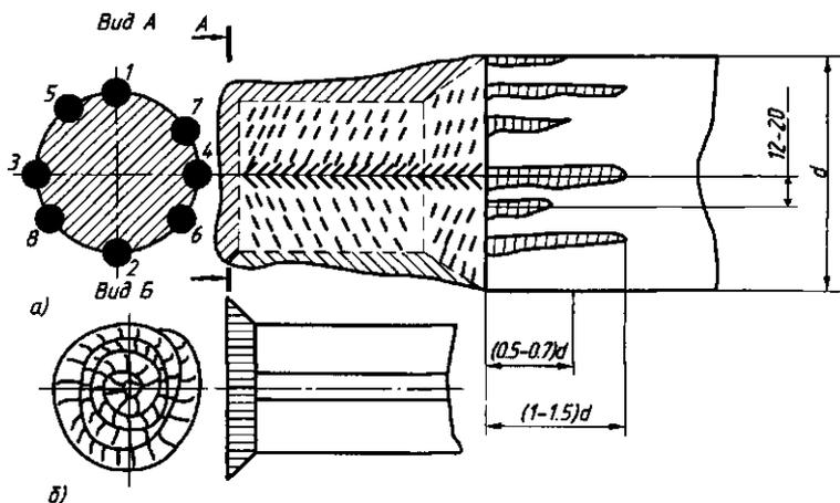
Рис. 9.5. Эскизы валов, у которых электродуговой наплавкой восстанавливают посадочную поверхность (а) и торец (б)
