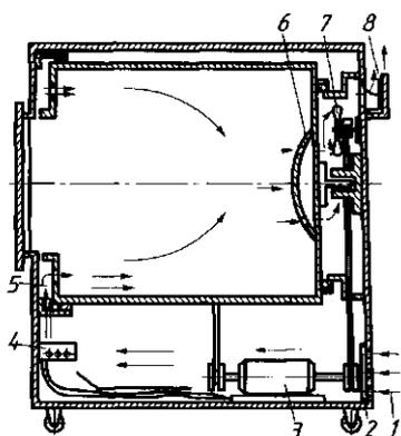
Рис. 5.4. Схема воздушного тракта сушильной машины:
