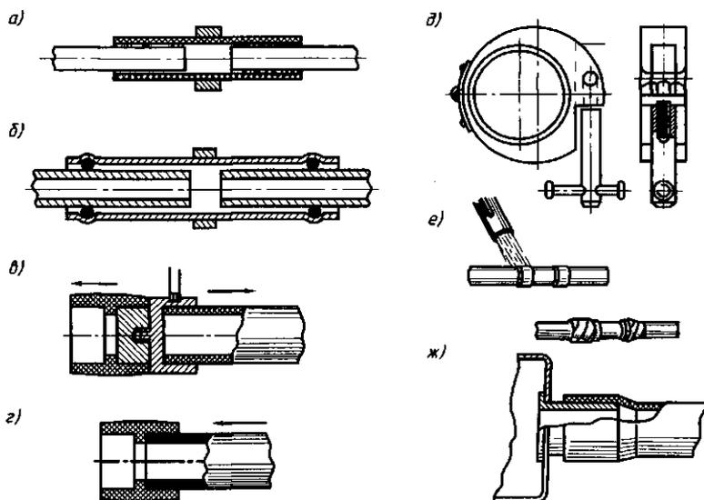
Рис. 2.15. Способы соединения пластмассовых труб:
