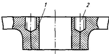
Рис. 9.3. Эскиз отремонтированной посадочной поверхности подшипникового шита
