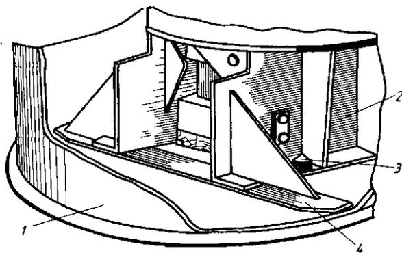
Рис. 3.34. Установка активной части на конусные шипы:
