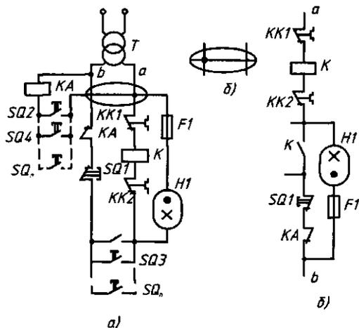
Рис. 14.10. Схема управления асинхронным электродвигателем ( $a$ ); дефект в ней ( $б$ ) и схема включения лампы ( $в$ )
