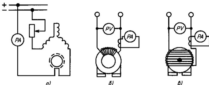
Рис. 3.8. Схемы подключения электрических машин при сушке током от постороннего источника (*а*) и индукционным способом (*б, в*)
