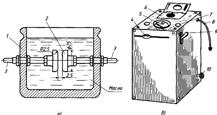
Рис. 12.20. Аппарат для определения пробивного напряжения масла: а — стандартный разрядник; б — внешний вид (1 — фарфоровый сосуд; 2 — плоский электрод; 3 — токоведущий стержень; 4 — рукоятка регулировочного трансформатора; 5 — киловольтметр; 6 — отверстие с крышкой для разрядника; 7 — сигнальная лампа; 8 — кабель для включения в сеть; 9 — рукоятка автомата включения; 10 — клемма заземления)
