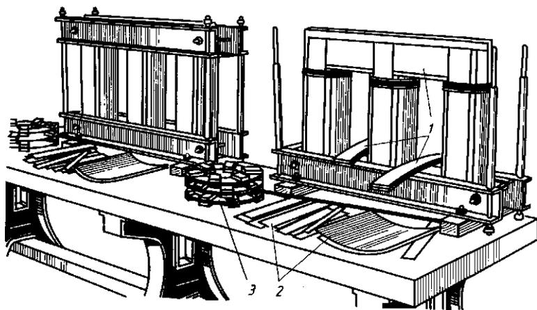
Рис. 12.10. Расшировка верхнего ярма трансформатора мощностью 100 кВ·А: 1 — пластины ярма; 2 — детали, подготовленные к сборке; 3 — ярмовая изоляция
