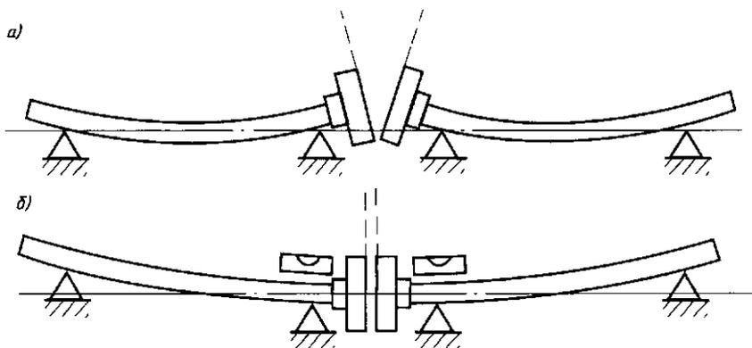
Рис. 3.23. Положение валов, соединяемых с помощью полумуфт:
