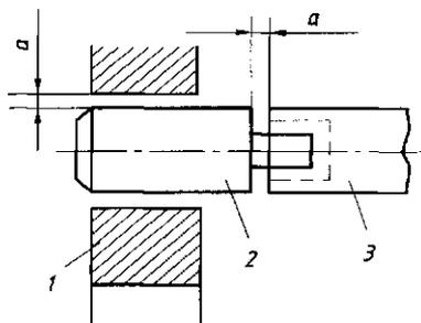
Рис. 9.11. Установка вставки стержня сварной короткозамкнутой обмотки
