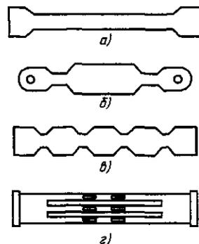
Рис. 14.3. Варианты исполнения плавких вставок: а — постоянного сечения; б — переменного сечения (фигурные вставки) на напряжение преимущественно не выше 220 В; в — переменного сечения на напряжение выше 380 В; г — для предохранителя с наполнителем
