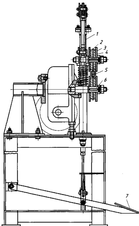
Рис. 10.3. Станок для удаления корпусной изоляции катушек
