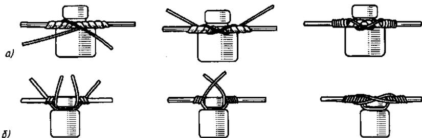
Рис. 2.21. Крепление проводов на изоляторах:
