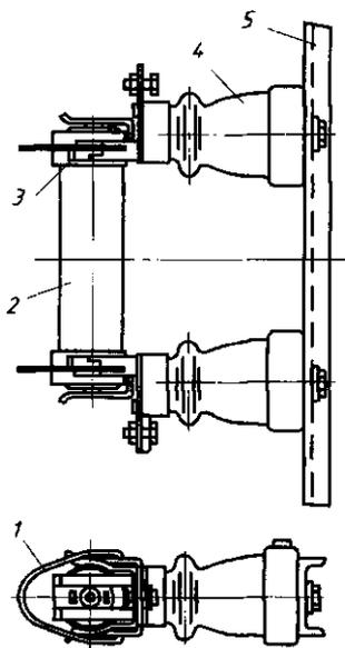
Рис. 14.6. Предохранитель ПК:
