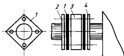
Рис. 11.14. Установка уплотняющих прокладок на фланцах радиатора
