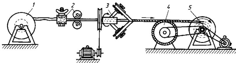
Рис. 12.4. Схема бумагоплеточного станка
