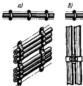
Рис. 2.18. Крепление кабелей АВРГ, АВВГ, АНРГ и проводов АТПРФ скобками (*a*) и полосками с пряжками (*б*)
