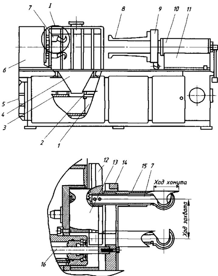
Рис. 8.11. Станок типа УПО-1 для удаления обмотки из статоров:
