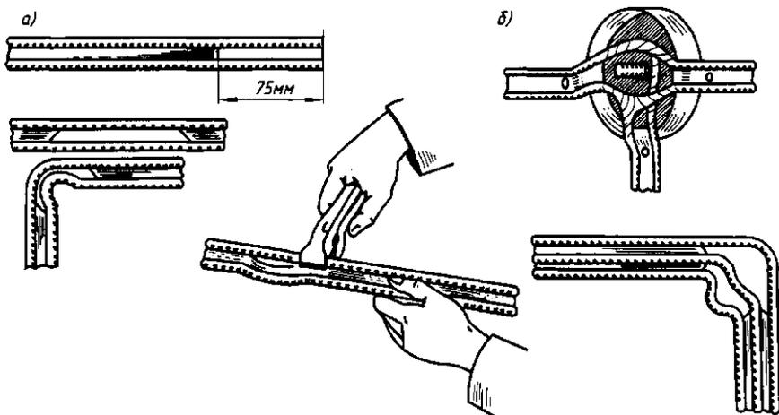
Рис. 2.14. Разделка плоских проводов:
