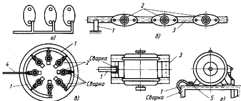
Рис. 2.25. Присоединение заземляющих проводников к корпусам аппаратов и к металлическим конструкциям (*а* — опорных изоляторов при их установке на бетонном или кирпичном основании; *б* — опорных изоляторов при их установке на металлических конструкциях; *в* — бетонных реакторов; *г* — электродвигателей):
