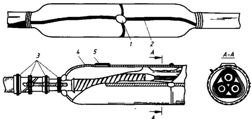
Рис. 2.4. Свинцовая соединительная муфта кабелей напряжением 6 и 10 кВ: 1 — участок присоединения заземляющего провода к корпусу муфты; 2 — заземляющий провод; 3 — проволочные бандажы; 4 — корпус; 5 — заливочное отверстие, закрытое свинцовой пластиной
