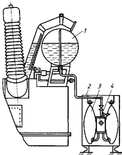
Рис. 6.4. Устройство азотной защиты:
