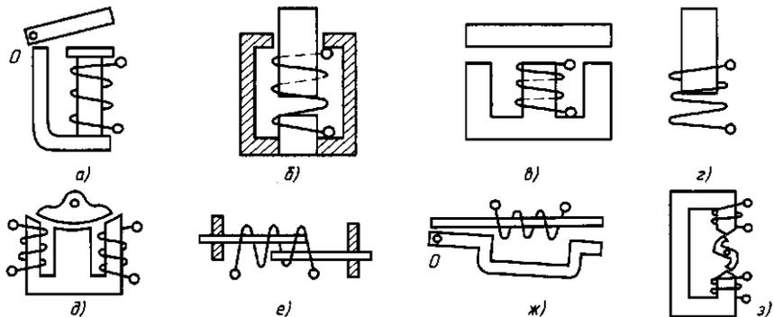
Рис. 4.1. Электромагнитные системы электрических аппаратов: *а* — клапанная; *б* — броневая; *в* — Ш-образная; *г* — открытый соленоидный электромагнит; *д* — с поворотным якорем; *е* — открытая с ферромагнитными токоведущими пластинами; *ж* — плоская для многоконтактных реле; *з* — с Z-образным якорем для реле защиты
