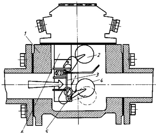
Рис. 6.1. Газовое реле
