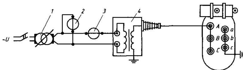
Рис. 12.21. Схема испытания изоляции обмотки ВН приложенным напряжением:
