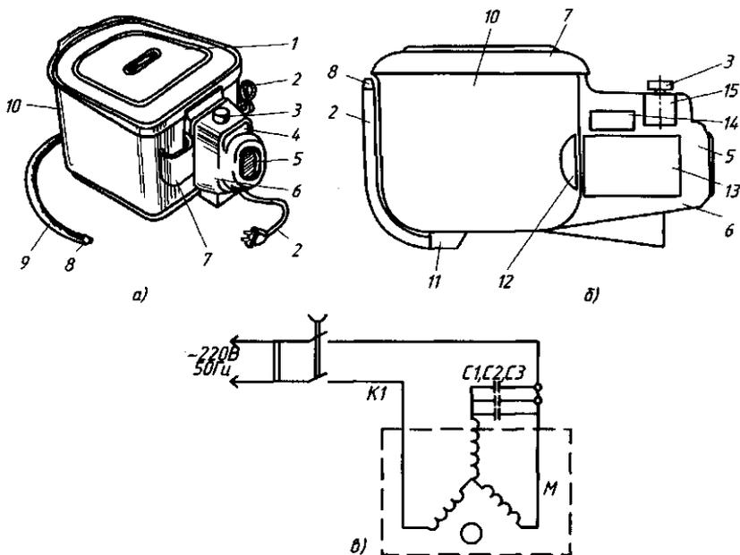
Рис. 5.2. Стиральная машина СМ-1 (а — внешний вид; б — схема; в — принципиальная электрическая схема):
