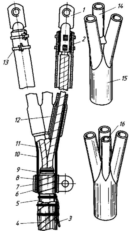
Рис. 2.11. Концевая заделка КВР (а — устройство; б — общий вид резиновых перчаток для трех- и четырехжильных кабелей):
