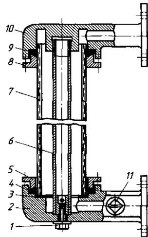
Рис. 3.31. Маслоуказатель трансформаторов III и IV габаритов:
