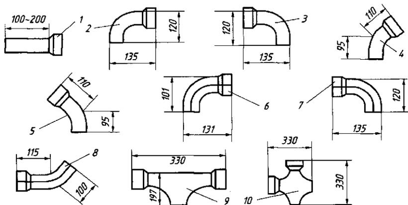
Рис. 2.20. Короба и детали для прокладки осветительных проводов:
