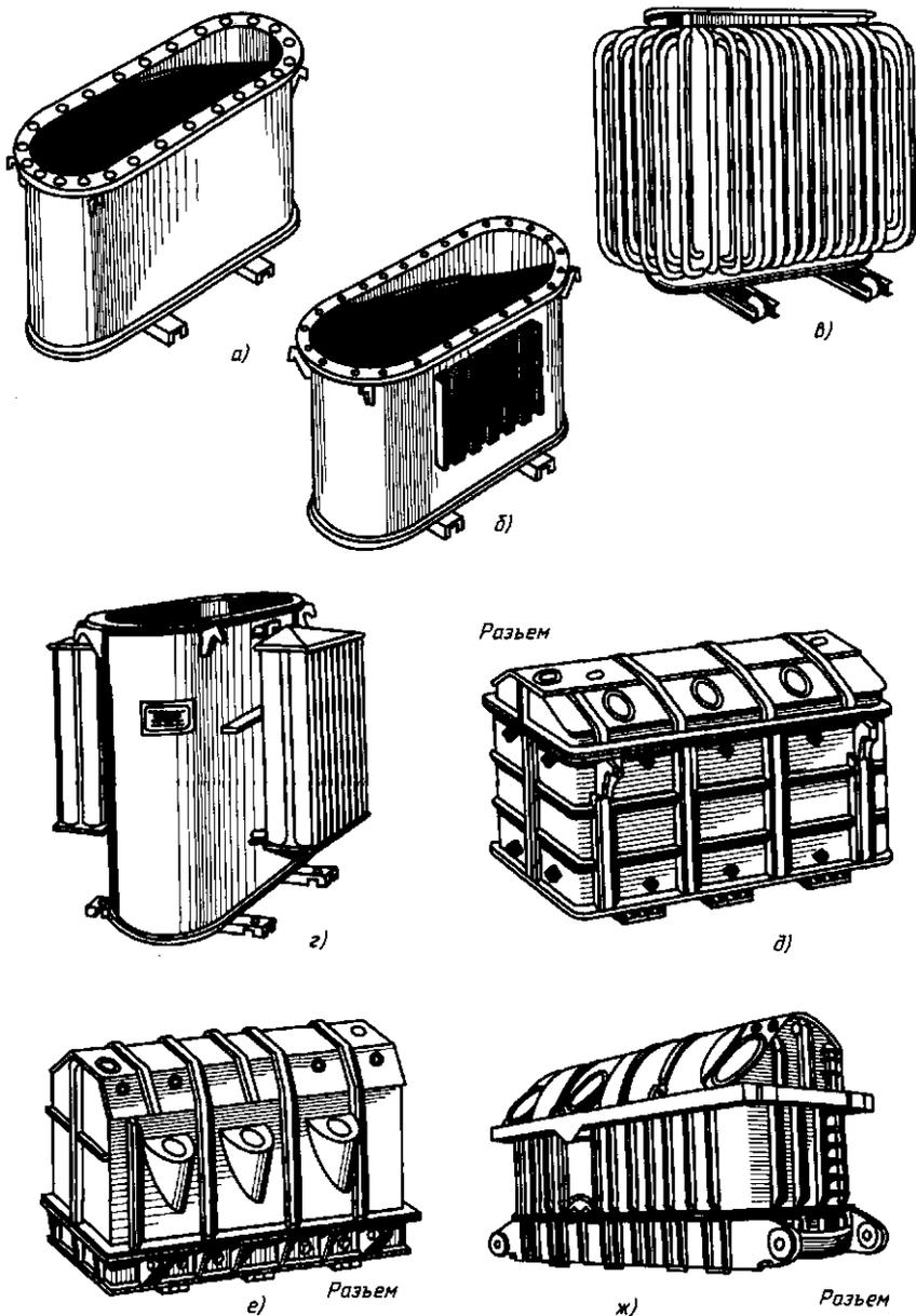
Рис. 3.26. Баки силовых трансформаторов:
