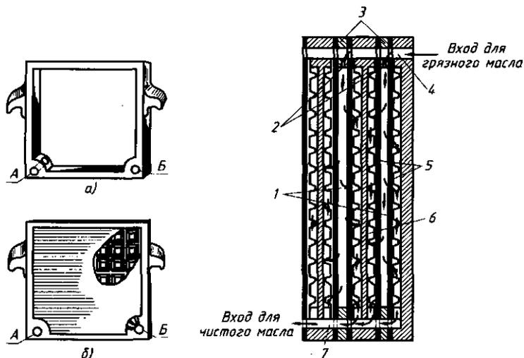
Рис. 12.18. Детали фильтр-пресса (а — рама; б — пластина) и схема его работы (в):
