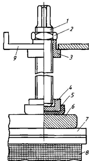
Рис. 11.5. Схема прессовки обмоток кольцами и нажимными винтами
