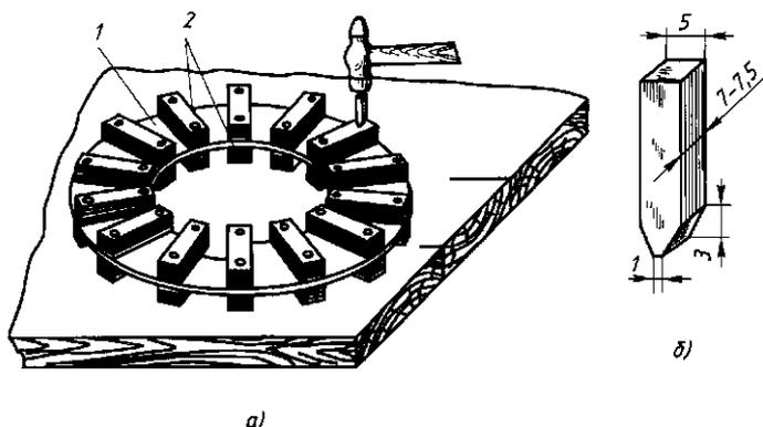
Рис. 12.9. Сборка ярмовой изоляции обмотки трансформатора III габарита:
