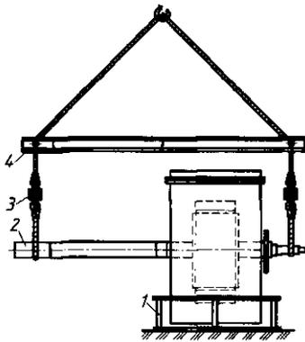
Рис. 8.7. Приспособление для вывода ротора электрических машин 15...19 габарита
