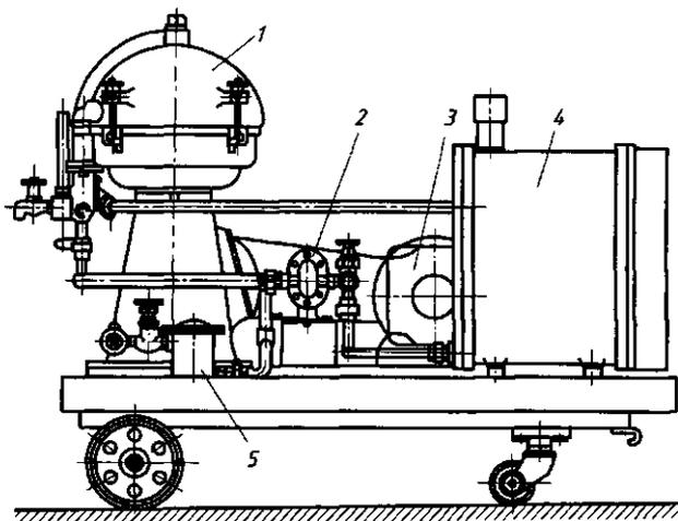
Рис. 12.16. Общий вид центрифуги для очистки масла
