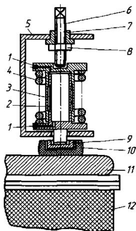
Рис. 11.8. Эскиз гидропружинного запорного устройства
