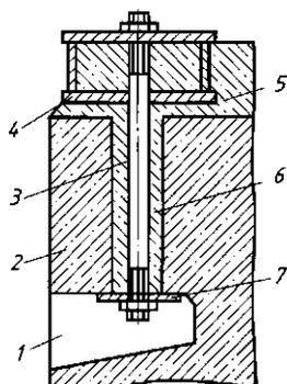
Рис. 3.3. Колодец в фундаменте для установки фундаментных болтов:
