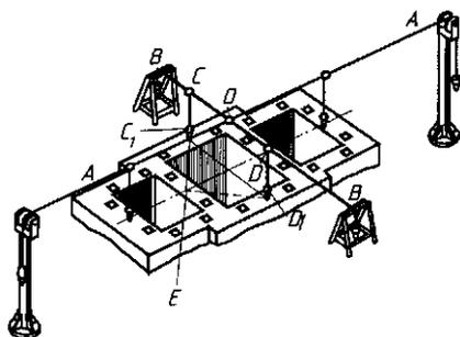
Рис. 3.2. Схема разметки главных осей фундамента:
