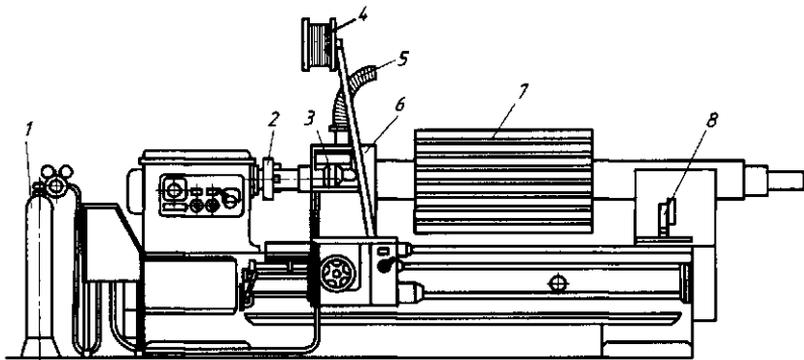
Рис. 9.6. Установка газоплазменного напыления
