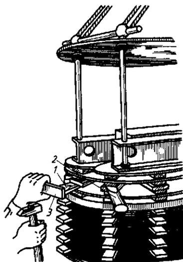
Рис. 11.4. Обмотки трансформатора с прессующими клиньями:
