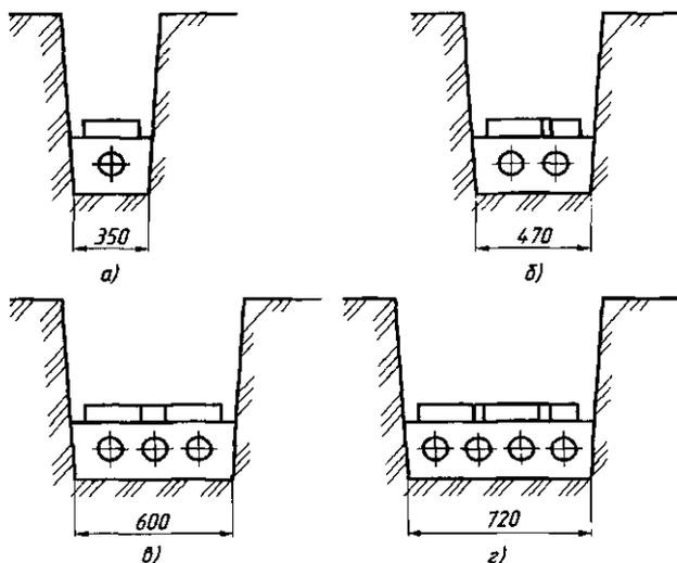
Рис. 2.2. Размеры кабельных траншей (мм) и размещение в них кабелей:
