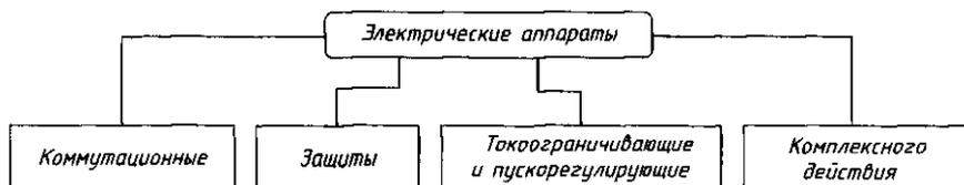
Рис. 14.1. Основные типы электрических аппаратов
