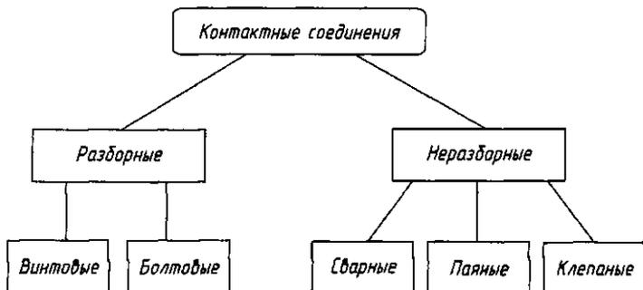
Рис. 13.2. Контактные соединения
