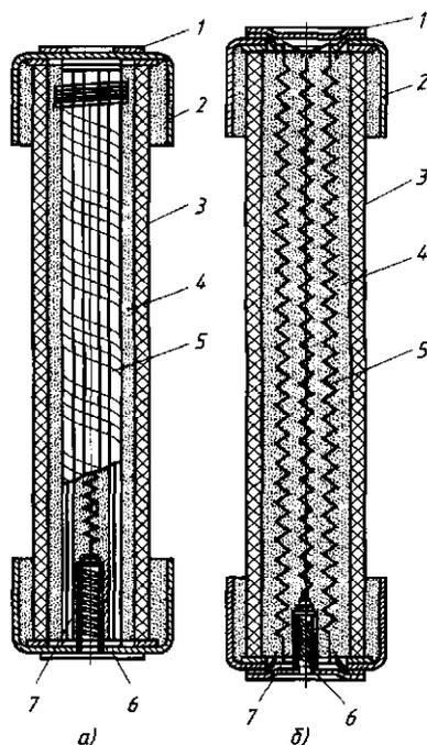
Рис. 14.5. Патроны предохранителей ПК с плавкими вставками на керамическом сердечнике (а) и свитыми в спираль (б): 1 — крышка; 2 — латунный колпачок; 3 — фарфоровая трубка; 4 — кварцевый песок; 5 — плавкие вставки; 6 — указатель срабатывания; 7 — пружина
