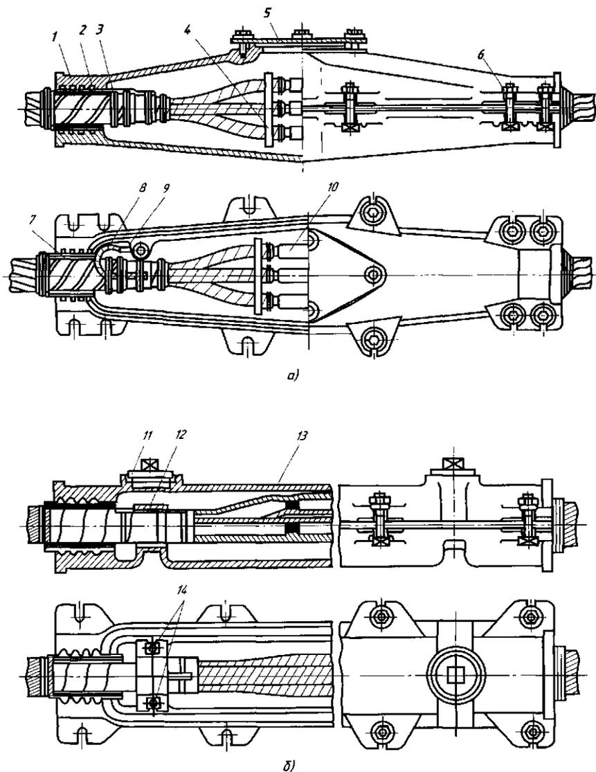
Рис. 2.3. Чугунные соединительные муфты для кабелей до 1 кВ
