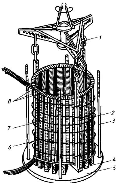
Рис. 12.5. Транспортировка обмотки:
