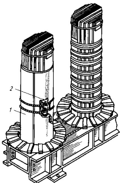
Рис. 12.11. Стяжка стержней и установка изоляционного цилиндра: 1 — мягкий цилиндр из электрокартона; 2 — приспособление для его затяжки
