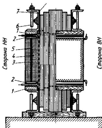
Рис. 12.2. Эскиз активной части трансформатора (боковая проекция):
