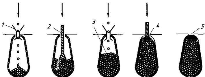
Рис. 10.2. Эскизы пазы в процессе «всыпания» витков обмотки
