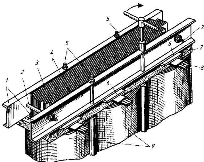
Рис. 12.15. Прессовка обмоток и ярма
