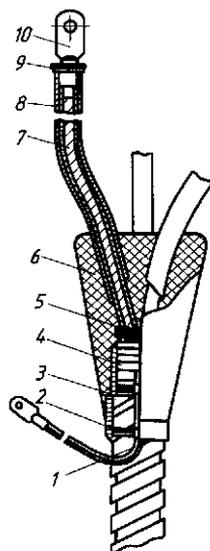
Рис. 2.9. Концевая заделка КВЭн: 1 — провод заземления; 2 — проволочный бандаж провода заземления; 3 — двухслойная подмотка; 4 — оболочка кабеля; 5 — бандаж из суровых ниток на поясной изоляции; 6 — корпус из эпоксидного компаунда; 7 — токопроводящая жила в заводской изоляции; 8 — трубка из найритовой резины; 9 — бандаж или хомут; 10 — наконечник
