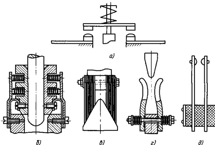
Рис. 4.3. Размыкающие контакты: а — мостиковые; б — решеточные; в — щеточные; г — пальцевые; д — с плоскими пружинами
