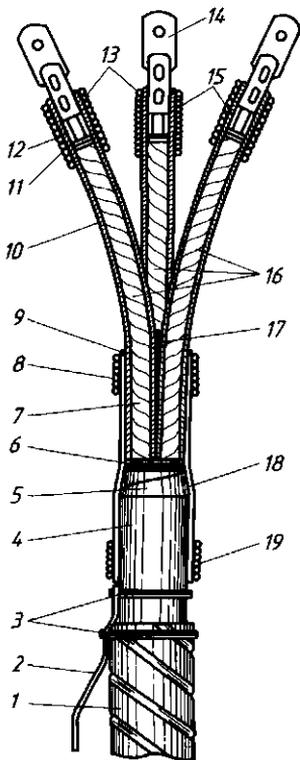
Рис. 2.10. Концевая заделка КВВ:
