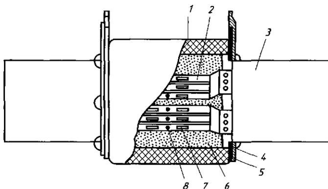
Рис. 14.4. Предохранитель ПН-2:
