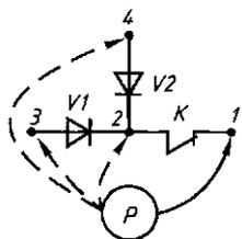
Рис. 13.9. Образование цепи через диоды
