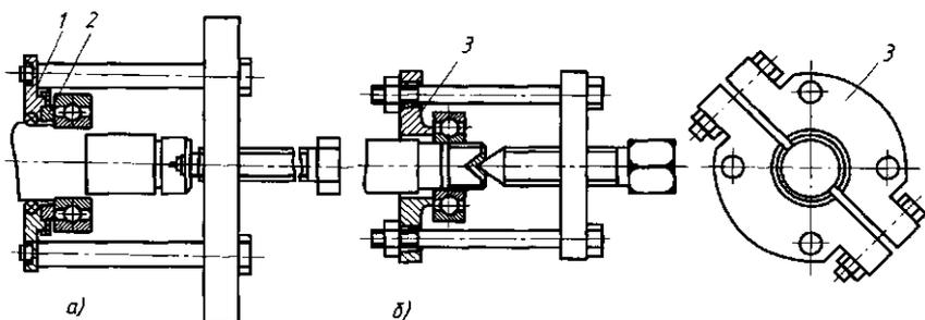
Рис. 8.4. Снятие подшипников с использованием вставок (а) и хомута (б):
