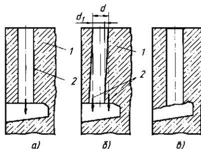
Рис. 3.4. Правильное (а) и неправильное (б, в) выполнение колодцев под фундаментные болты:
