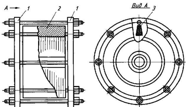
Рис. 9.9. Приспособление для снятия сердечника с вала:
