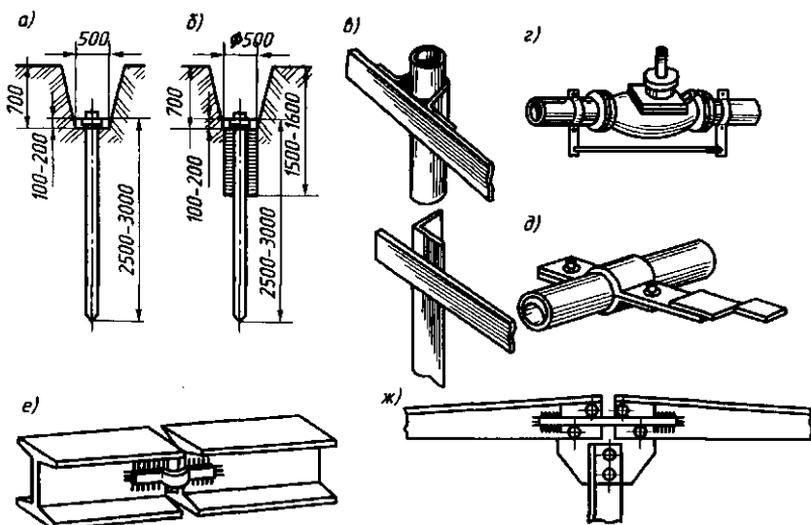
Рис. 2.23. Устройство заземления:
