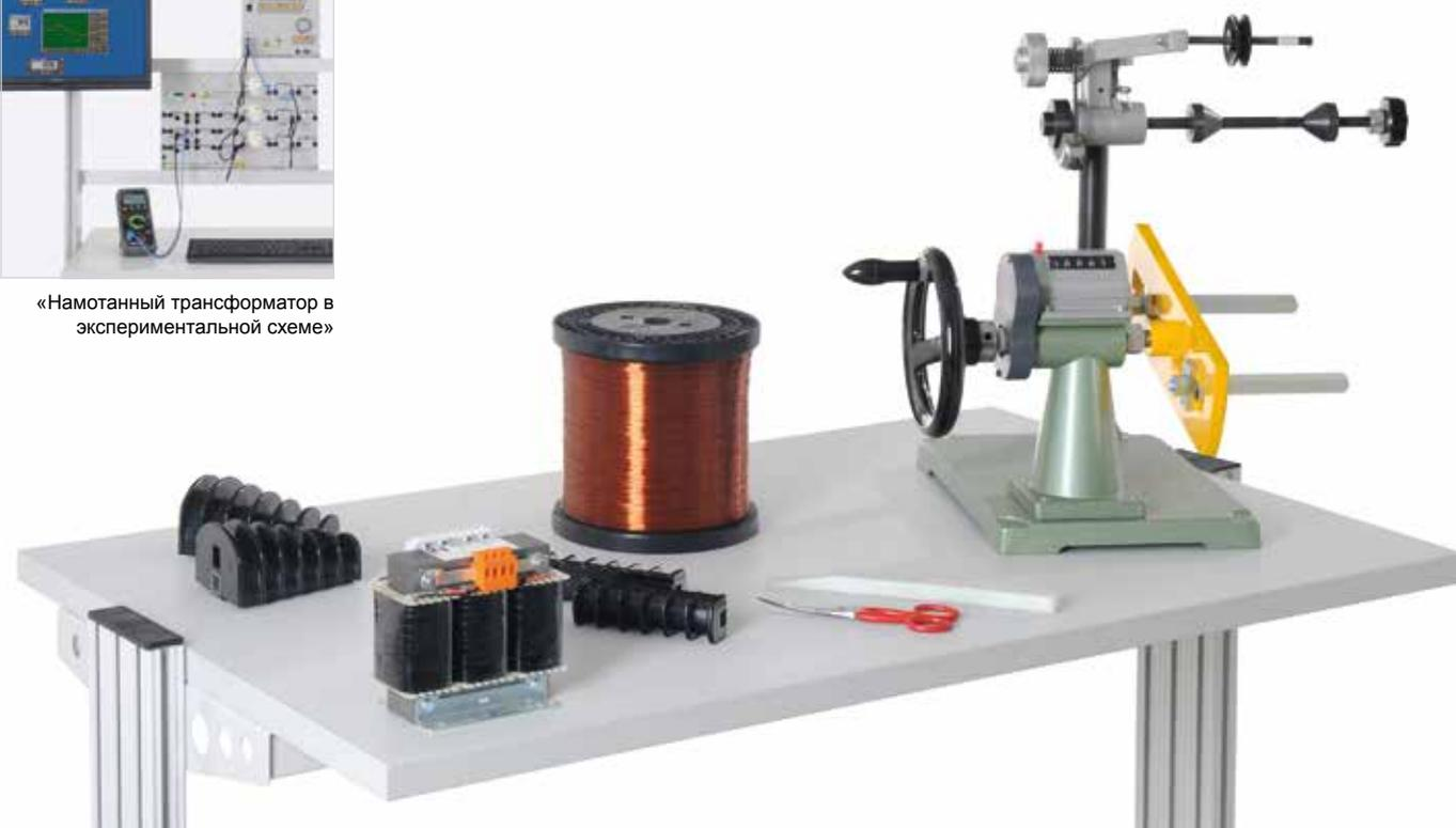
Пример эксперимента: «Обмотка трансформаторов EWM 10»
