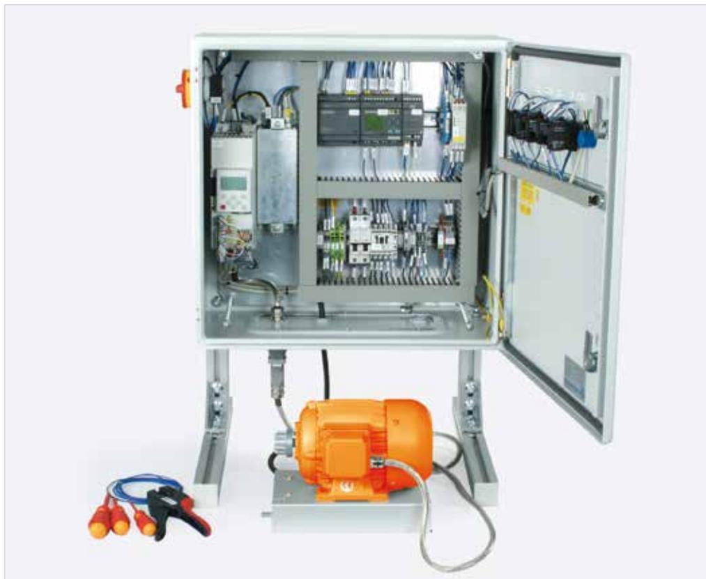
Эксперимент: «Практическая работа с преобразователем частоты EPL 25»
