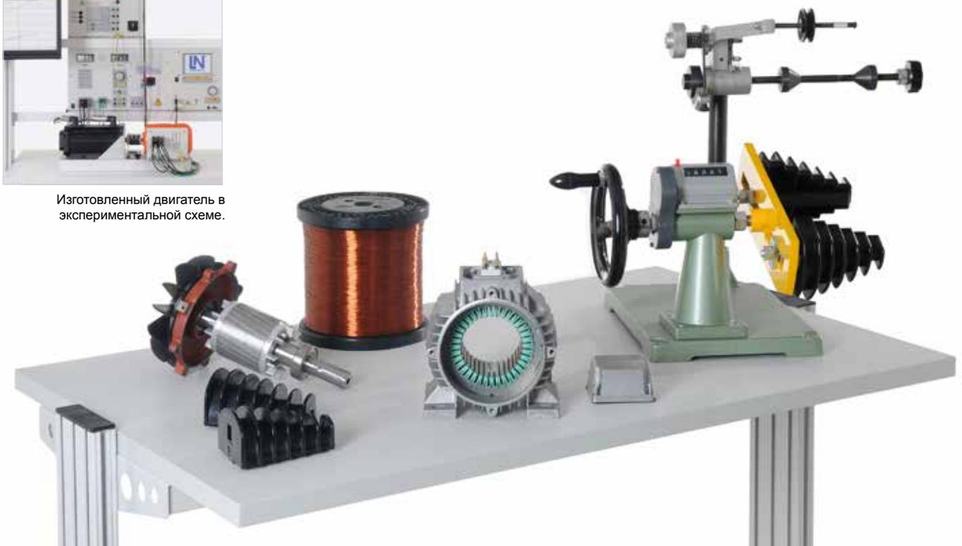
Пример эксперимента: «Намотка трехфазного асинхронного двигателя с короткозамкнутым ротором EWM 20»
