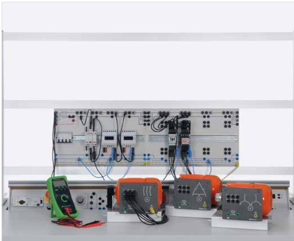
Эксперимент: «Контакторные цепи в трехфазной цепи EST 2»
