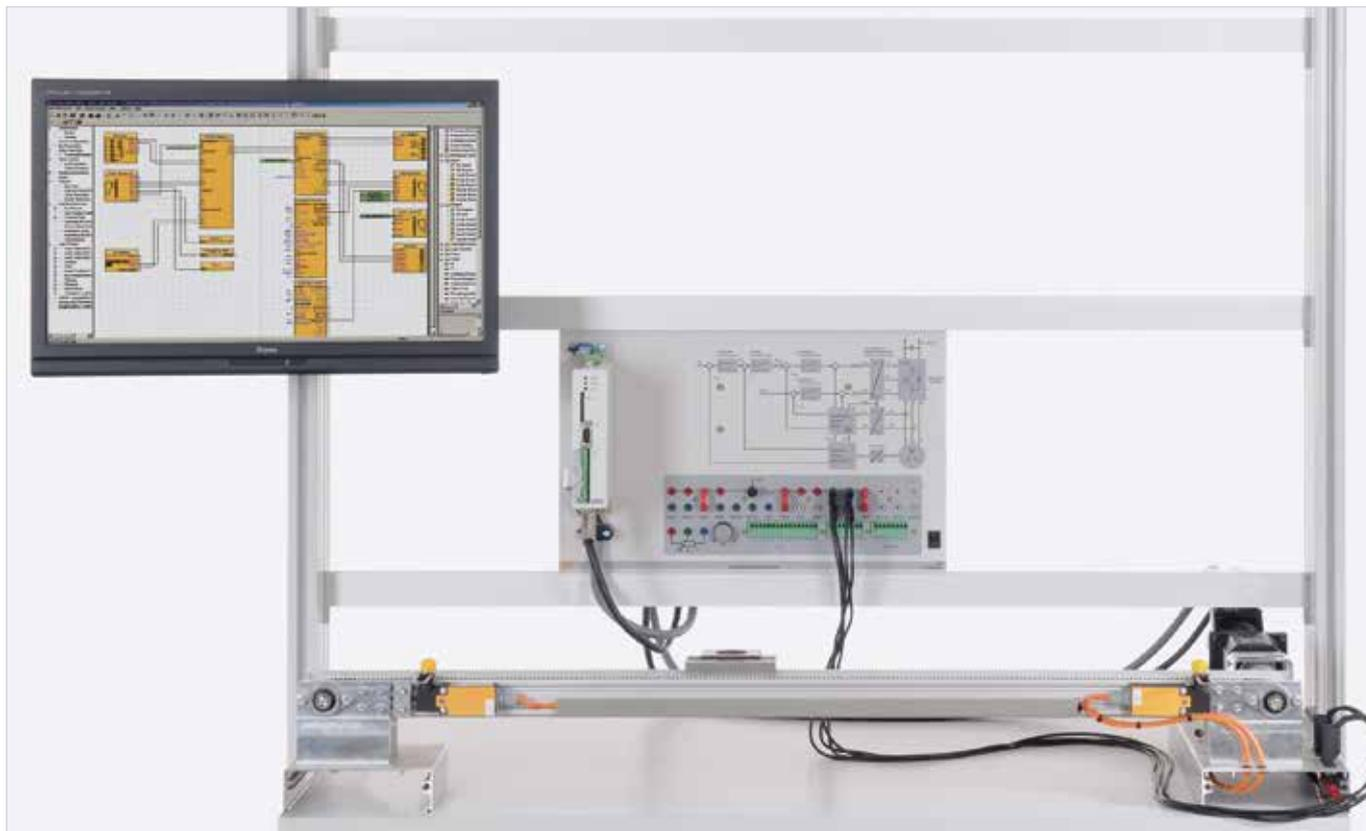
Эксперимент: «Позиционирование с помощью синхронной сервосистемы EDT 32»
