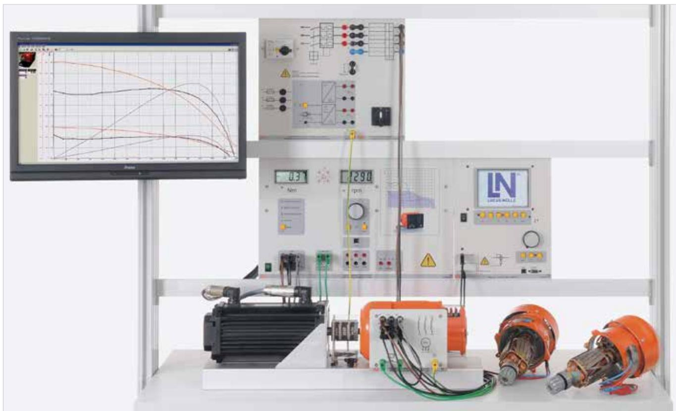
Пример эксперимента «Разборный трехфазный машинный агрегат EEM 10»
