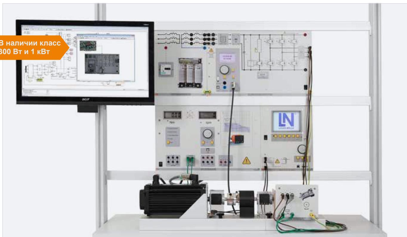
Обучающая система «Регулируемые сервоприводы на постоянных магнитах с Matlab®/Simulink® и испытательным стендом для серво-механизмов»
