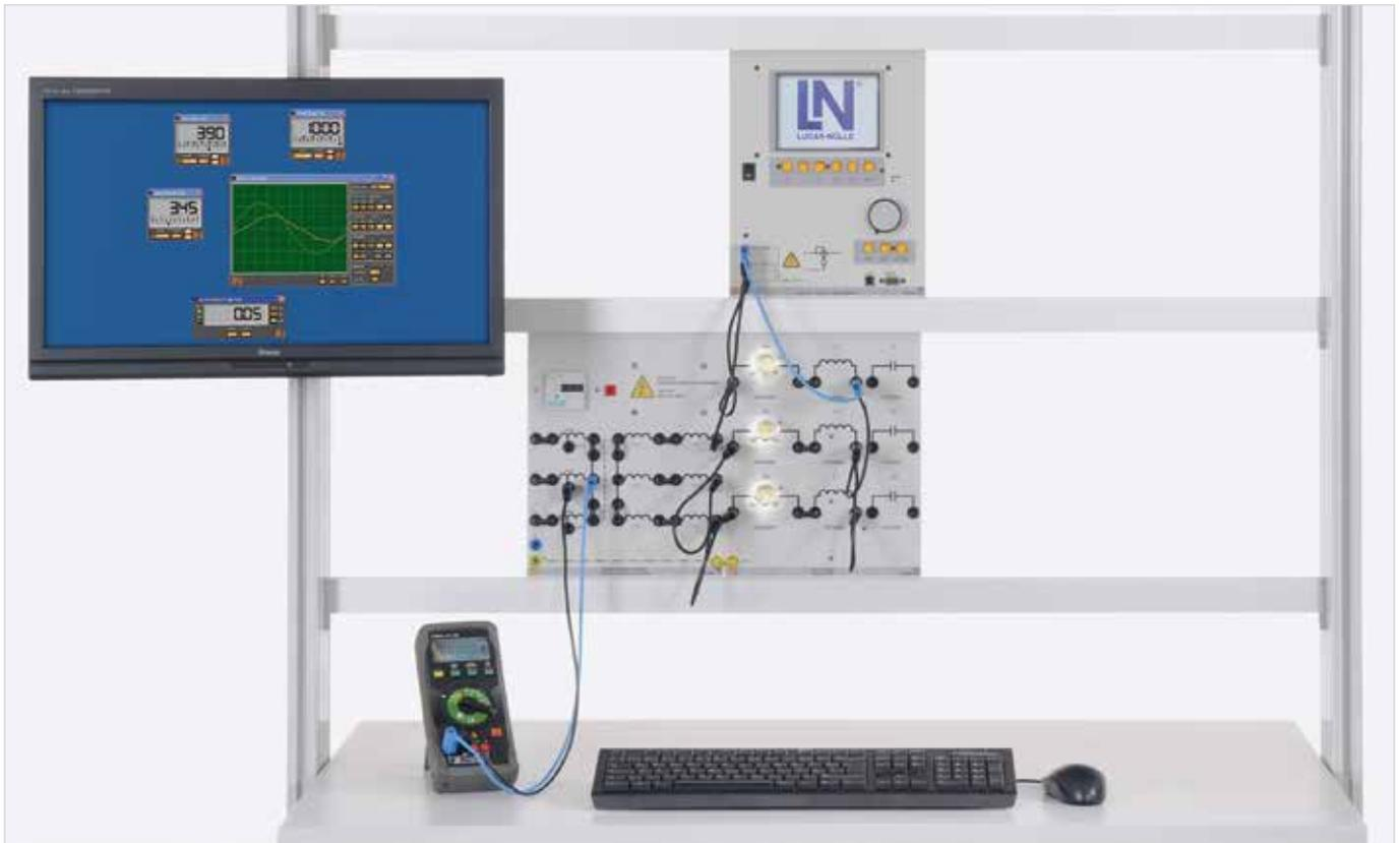
Эксперимент: «Однофазный и трехфазный трансформаторы ENT 5»
