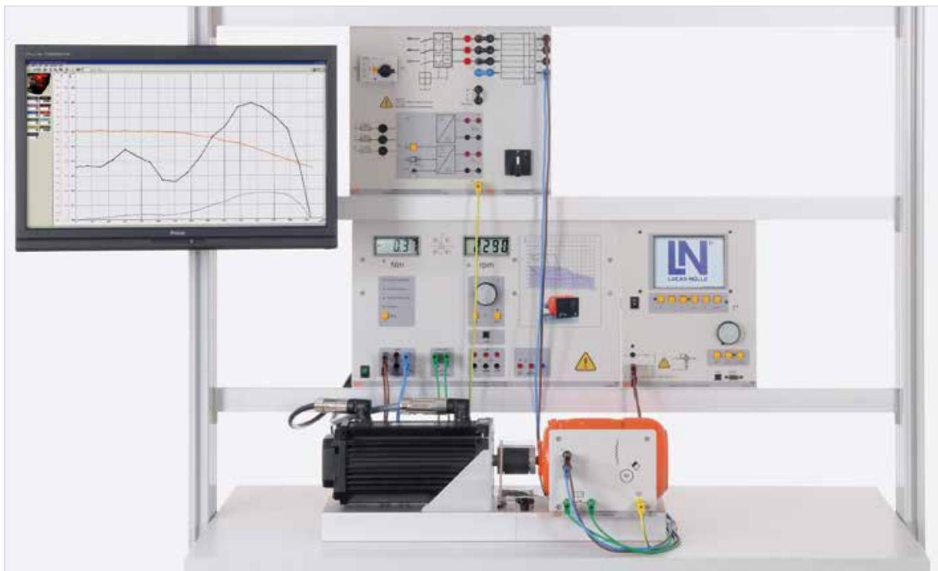
Эксперимент «Двигатель с расщепленным полюсом EEM 3.5»
