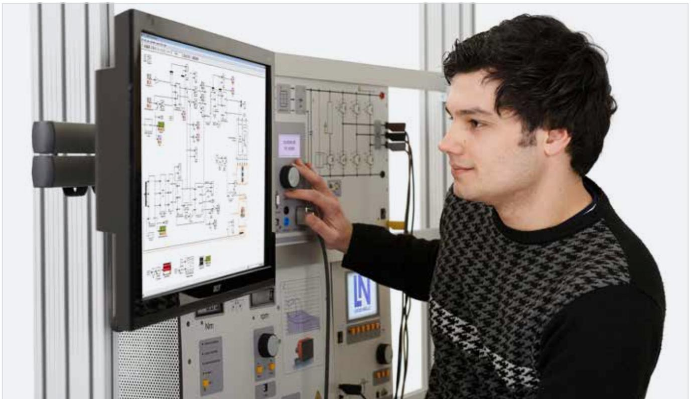
Обучающая система: «Регулирование возбуждения асинхронных двигателей с помощью Matlab®/Simulink®»
