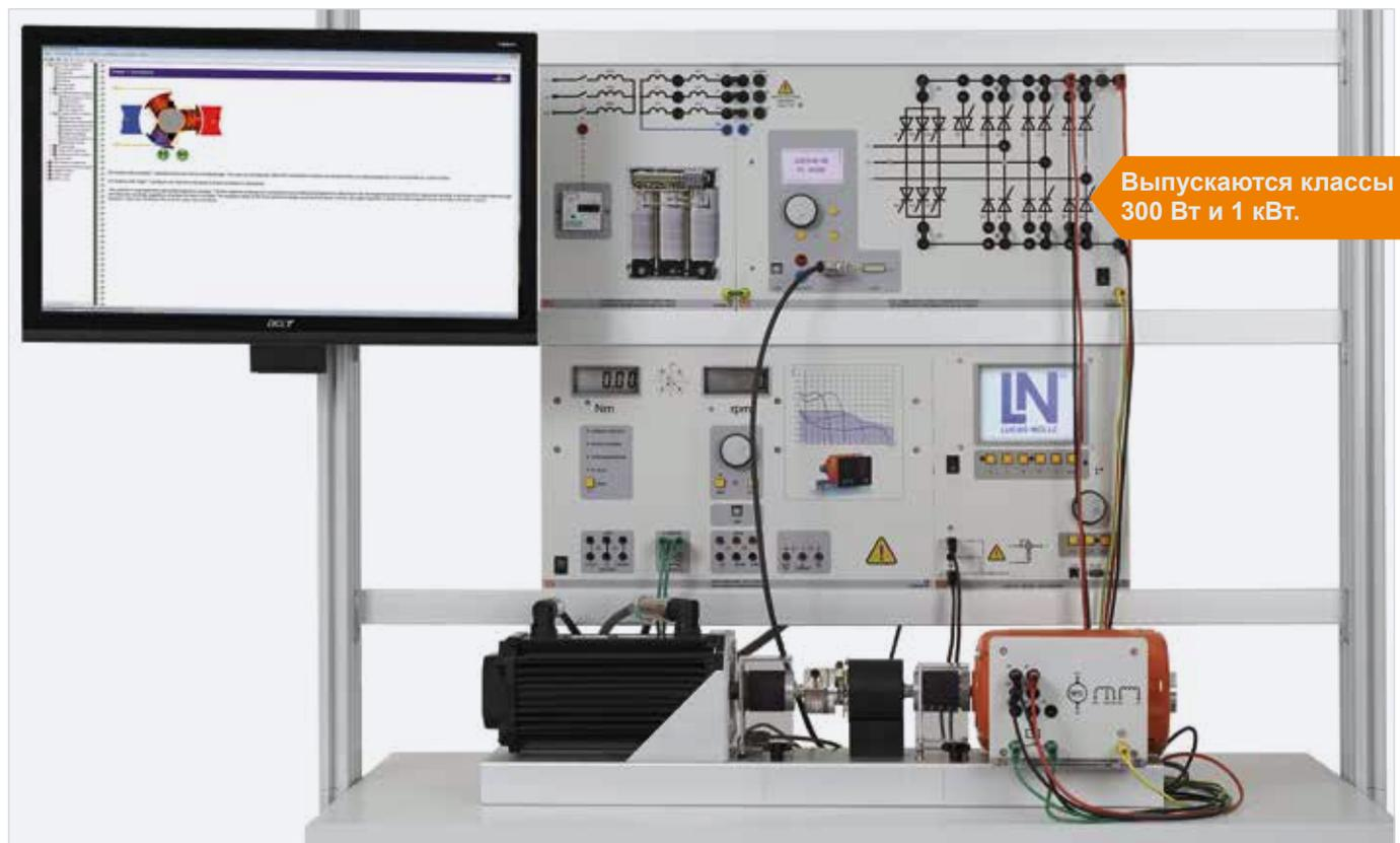
Обучающая система по электроприводам с преобразователями электроэнергии и двигателем постоянного тока
