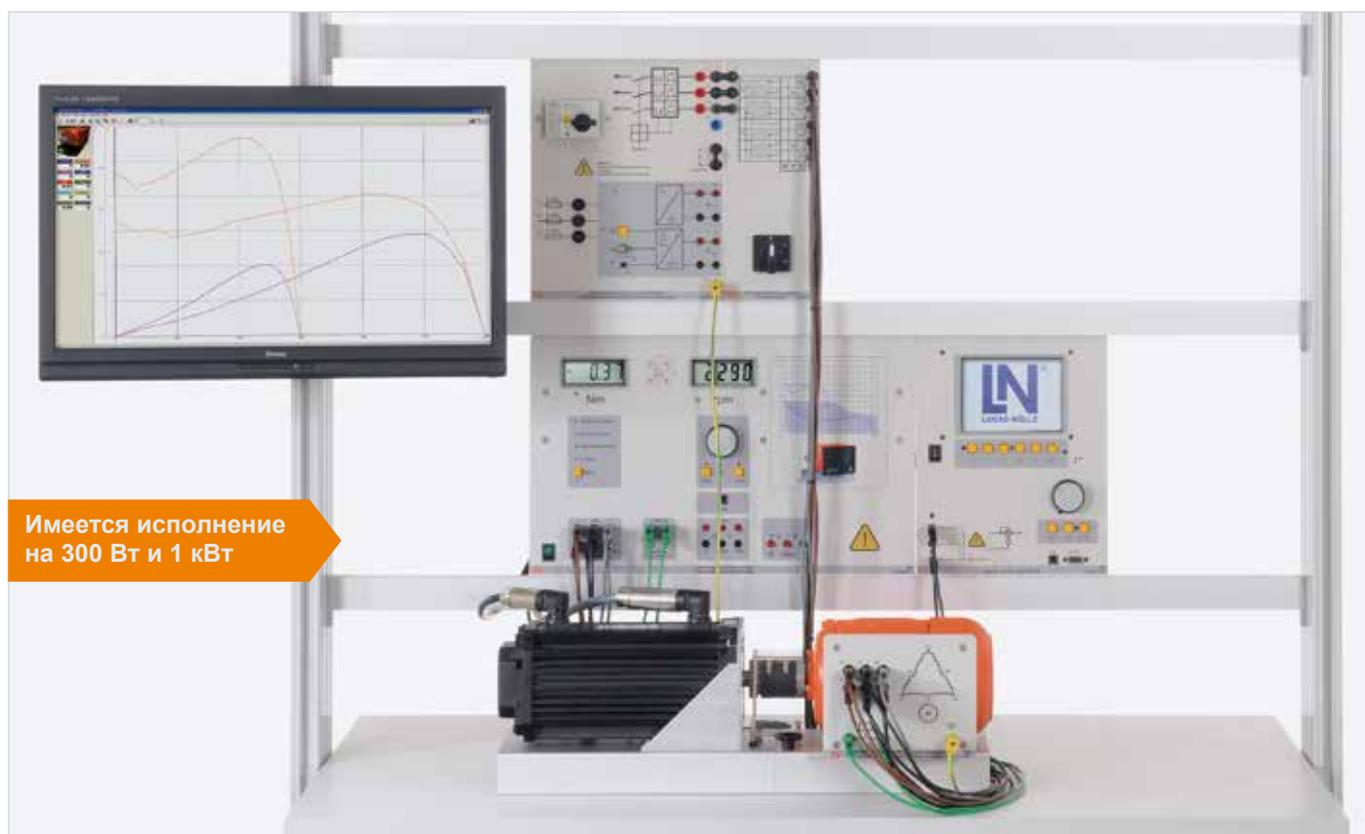
Эксперимент «Трехфазный двигатель с переключателем числа полюсов обмотки Даландера EEM 4.2»
