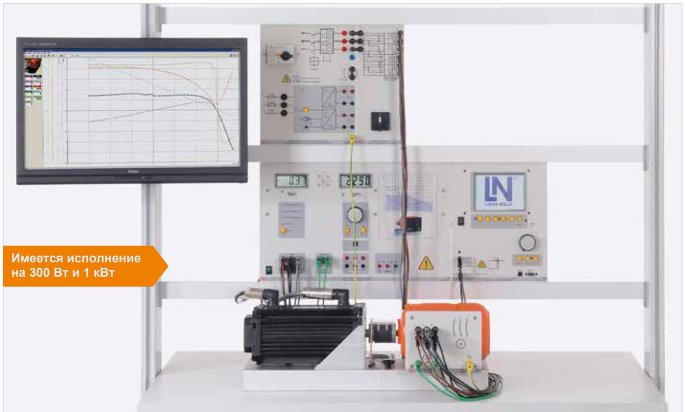
Эксперимент «Трехфазный двигатель с короткозамкнутым ротором ЕЕМ 4.1»
