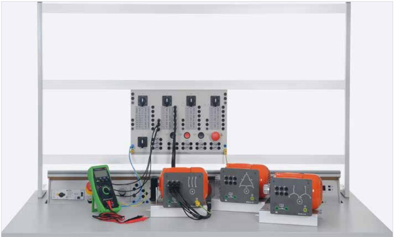
Эксперимент: «Ручная коммутация в трехфазной цепи EST 1»
