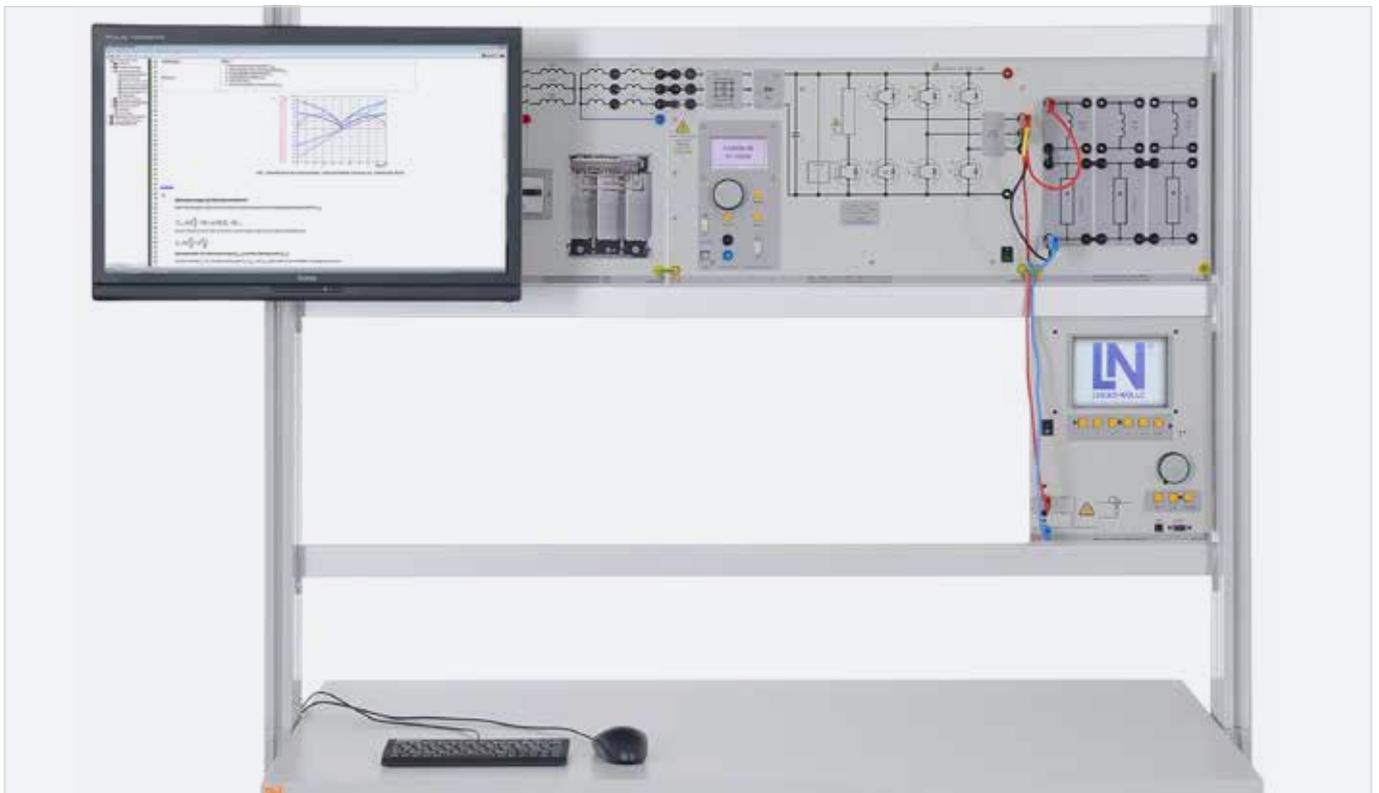
Обучающая система «Автономные полупроводниковые преобразователи с пассивной нагрузкой R-L»
