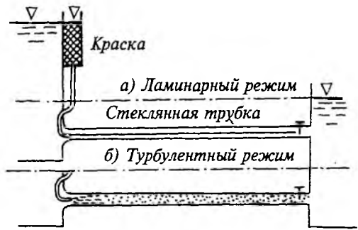
Рис. 5.12. Прибор Рейнольдса для изучения режимов движения жидкости
