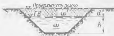
Рис. 6-5. Несовпадение минимальной площади живого сечения потока с минимальной площадью поперечного сечения земляной выемки
