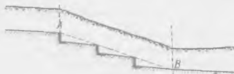
Рис. 6-9. Схема ирригационного канала с перепадами
