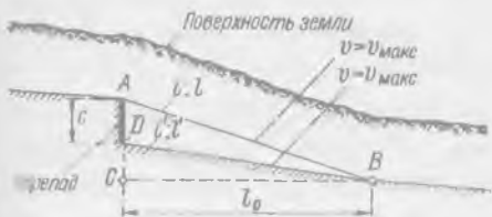
Рис. 6-8. Устройство перепада для снижения скорости v
