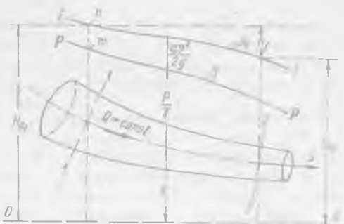
Рис. 3-25. Геометрическая интерпретация уравнения Бернулли для целого потока реальной жидкости при установившемся движении
