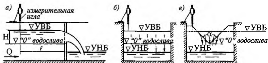
Рис. 12.8. Измерение расхода с помощью водослива: а — продольный разрез лотка для измерения расхода; б — вид нижнего бьефа прямоугольного водослива; в — вид нижнего бьефа треугольного водослива
