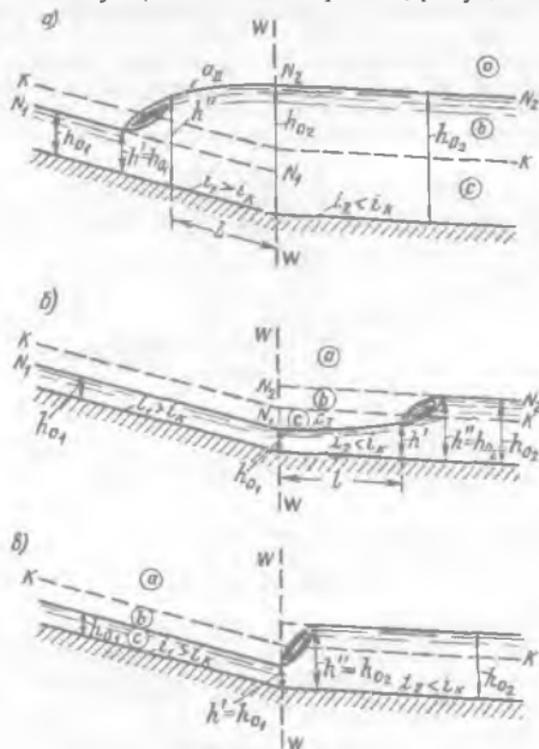
Рис. 8-8. К построению свободной поверхности в канале при наличии гидравлического прыжка
