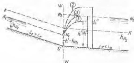
Рис. 8-9. К определению местоположения гидравлического прыжка в канале
