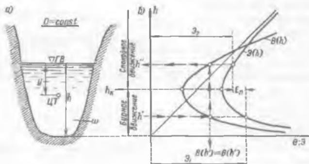
Рис. 8-4. График прыжковой функции  $\Theta(h)$
