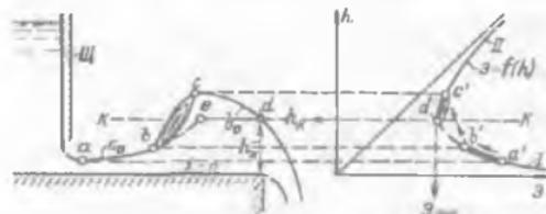
Рис. 8-2. Энергетическая интерпретация гидравлического прыжка
