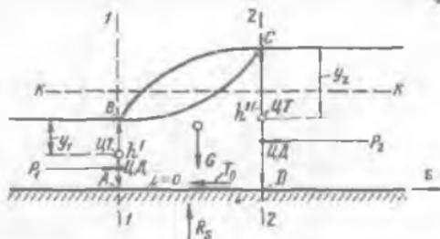
Рис. 8-3 Схема гидравлического прыжка
