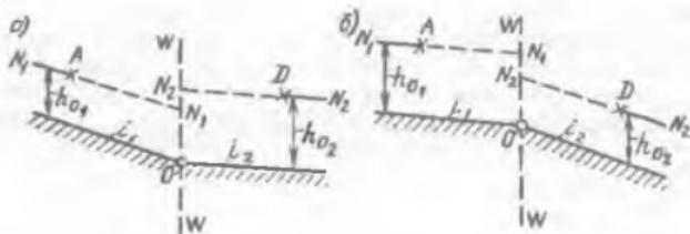
Рис. 8-6. Каналы с резким изменением уклона дна (в точке  $O$ )
