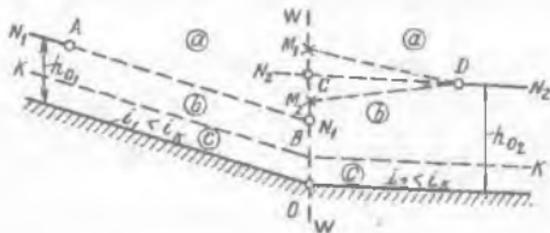
Рис. 8-7. К построению свободной поверхности в канале при отсутствии гидравлического прыжка
