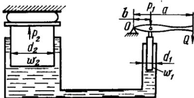
Рис. 1.18. Схема гидравлического прессы.
