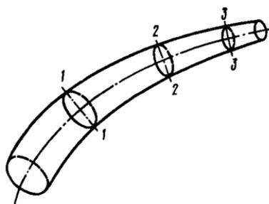
Рис. 1.22. Схема, демонстрирующая неразрывность потока жидкости.
