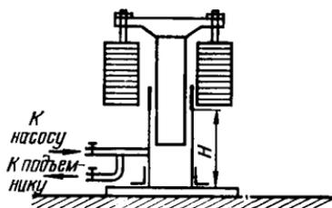
Рис. 1.19. Схема гидравлического аккумулятора.
