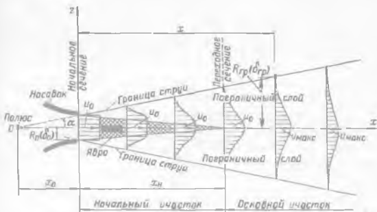
Рис. 10-26. Схема затопленной свободной турбулентной струи
