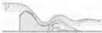
Рис. 12-36. Поверхностный режим с незатопленной струей
