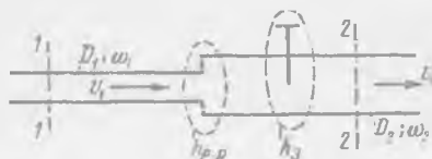
Рис. 5-2. Сложение потерь напора (при D \neq \text{const} )
