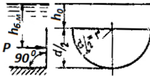
2.23-rasm. Yarim doira shaklidagi ko‘rinishga ega tekis sirtga ta’sir etuvchi gidrostatik bosim kuchi
