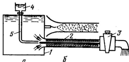
Рис. 1.25. Режимы движения жидкости:
