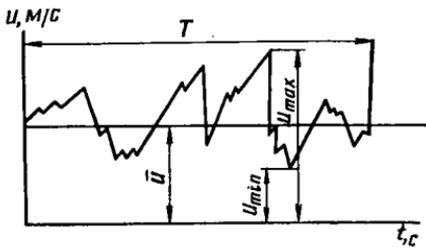
Рис. 1.28. График пульсации скорости.
