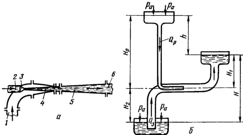
Рис. 2.34. Водоструйный насос:
