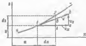
Рис. 18-4. К выводу дифференциального уравнения линии тока
