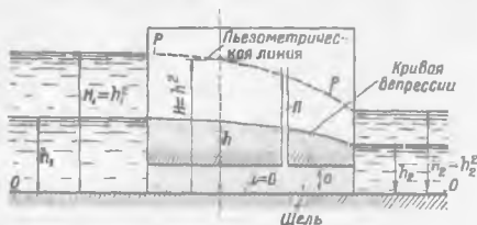
Рис 18-21. К пояснению замены безнапорного потока «плановым» напорным потоком
