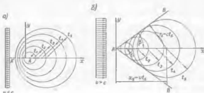
Рис. 15-7. Распространение волны возмущения на свободной поверхности потока: а — спокойное движение, б — бурное движение
