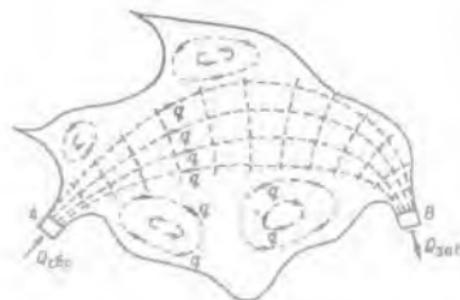
Рис. 15-2 Пример потока в плане (пруд-охладитель)
