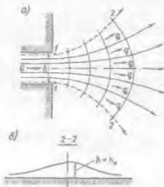
Рис. 15-4. Пример потока в плане (бурный поток в нижнем бьефе водосброса)
