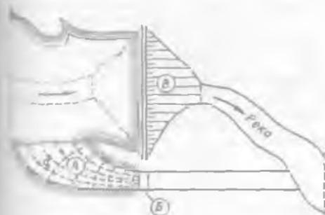
Рис 15-3 Пример потока в плане (подходная выемка А к водосливу Б)
