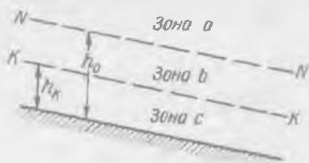
Рис. 7-25. Зоны расположения отдельных кривых свободной поверхности потока
