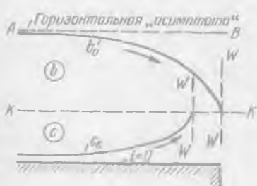
Рис. 7-34. Формы (виды) отдельных кривых свободной поверхности при i = 0 .
