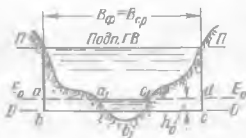
Рис. 7-45. Определение глубины h_0 для фиктивного прямоугольного русла
