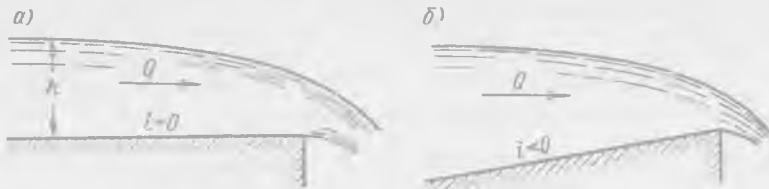
Рис. 7-3. Примеры неравномерного движения в цилиндрических каналах горизонтальных ( i = 0 ) и с обратным уклоном ( i < 0 )
