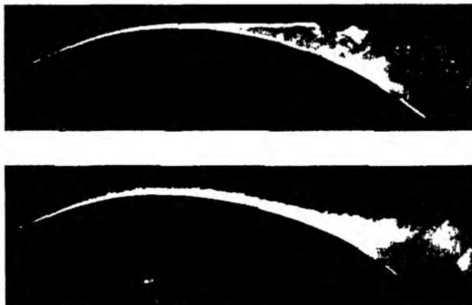
Рис. 16.20. Сравнение ламинарного и турбулентного пограничных слоев. Ламинарный пограничный слой, показанный на верхнем снимке, отрывается на вершине выпуклой поверхности, тогда как турбулентный слой, показанный на нижнем снимке, остается присоединенным
