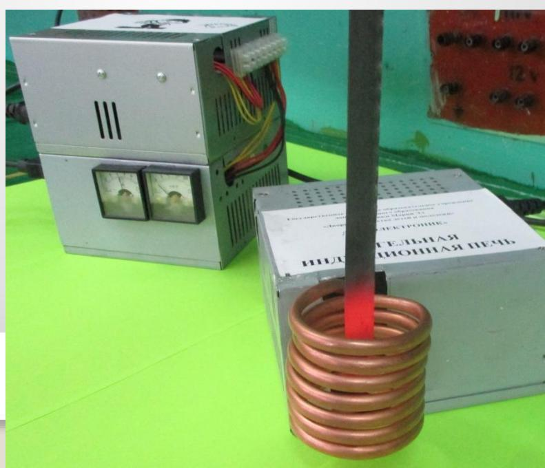
Силовые линии переменного магнитного поля индуктора
