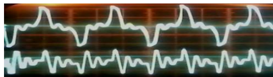
Рис.2. Осциллограмма импульсного (верх.) напряжения и тока разряда в генераторе озона Разработан новый способ проточную двукратную обработку питьевой воды (рис.3), а результаты испытаний приведены в табл. 2
