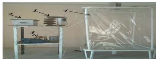
Рис.3. Общий вид экспериментальной установки для проточной обработки питьевой воды озоном методом диспергирования.
