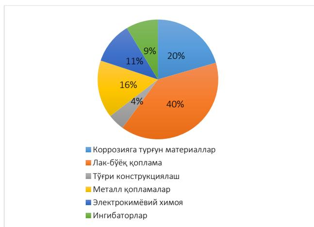
**4-расм. Металл конструкция элементларини коррозиядан химоялаш усуллари**
