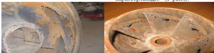
1-расм. Насос ишчи ғилдирагининг кавитация натижасида емирилиши.
