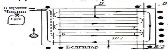
4-расм. Таклиф этилаётган далага бир жойдан кириш ва чиқиш билан амалга ошириладиган илмоқсиз моқисимон ҳаракатланиш усули: B – агрегатнинг қабраш кенлиги; 0, 1, 2 – агрегатнинг ҳаракатланиш цикли;
