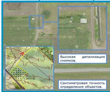
Рисунок 4: Создание ортофотопланов и электронных карт
