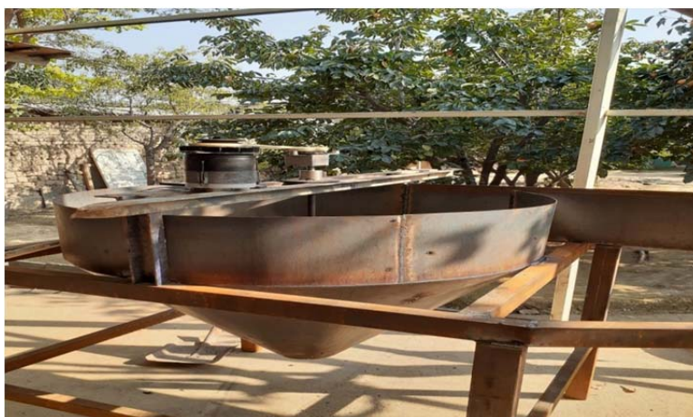
3-расм. Гравитацион (сув айланттирувчи) микроГЭСи.
