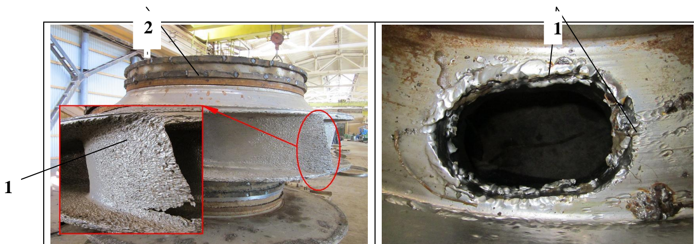
4-Расм. Насос ишчи ғилдирагининг кавитация ва гидроабразив заррачалар таъсирида ейилиши
