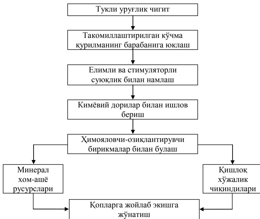
1-расм. Кўчма қобиқлаш қурилмасининг такомиллаштирилган вариантида тукли уруғлик чигитларни экишга тайёрлаш технологиясининг принципиал схемаси
