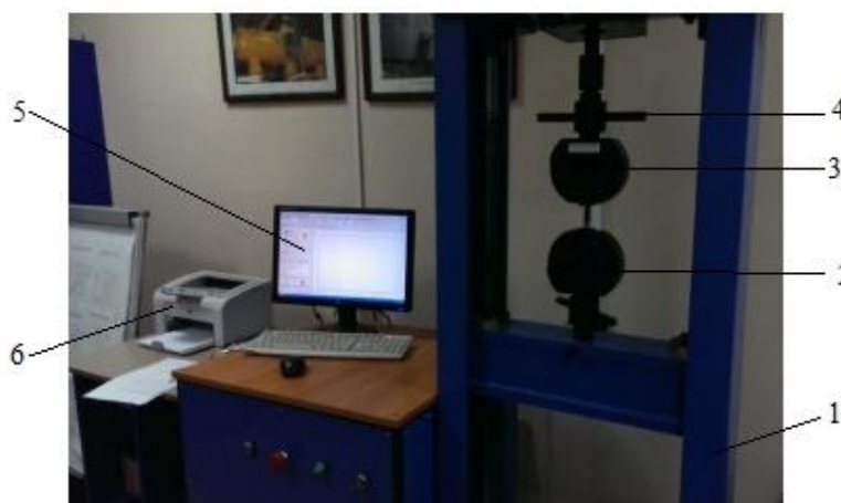
Рис. 3. Общий вид модернизированной разрывной машины Р-5: 1-рама; 2-нижний захват; 3-верхний захват; 4-дисплей компьютера; 5-принтер
