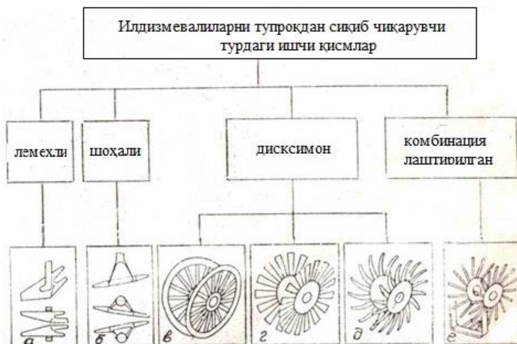
1 – расм. Сиқиб чиқарувчи ишчи қисмлар схемалари
