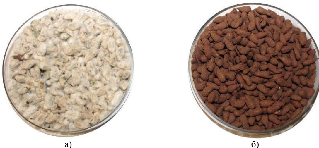
4.5-расм. Дастлабки тукли чигит (а) ҳамда кўчма қобиқлаш қурилмасида экишга тайёрланган (б) тукли чигитлардан намуналар
