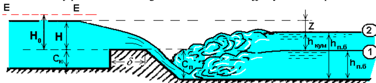
16.28-rasm - Amaliy profilli suv o'tkazgich sxemasi.
