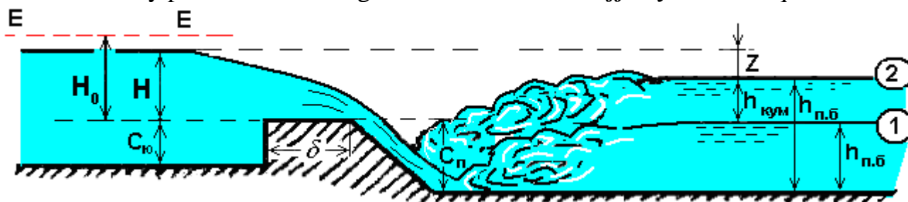
16.28-rasm - Amaliy profilli suv o'tkazgich sxemasi.
