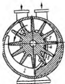
2.23 - rasm. Uyurmali nasoslarning ishlash prinsiplni tushuntirishga doir sxema.
