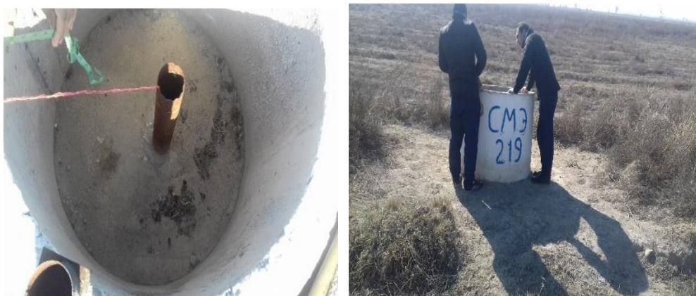
1-расм. Кузатув кудукларида ер ости сувларинг сатҳини ва минерализациясини ўлчаш жараёни
