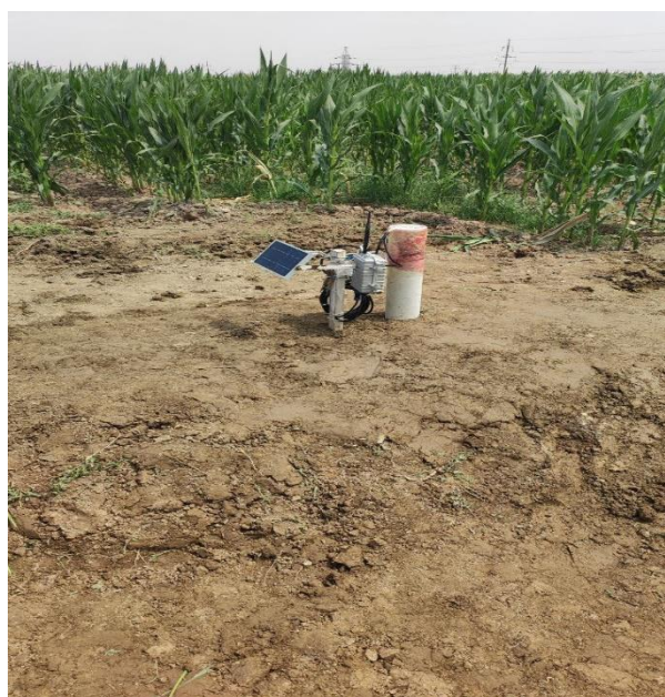
3.6-rasm. DIVER UIAPP V1.0 qurilmasi yordamida yer osti suvlari sathini o'lchash jarayoni
