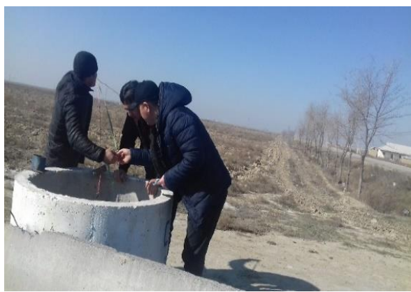
4.4-rasm. Kuzatuv quduqlarida yer osti suvlarning sathini o'lchash jarayoni
