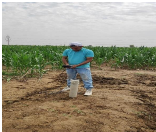
3.8-rasm. GPSMAP qurilmalari yordamida Qorasuv daryosi va yer osti suvlarini absolyut balandliklarini aniqlash jarayoni
