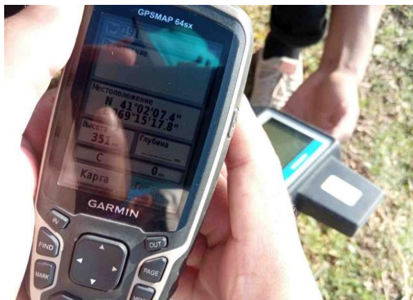
3.8-rasm. GPSMAP qurilmalari yordamida Qorasuv daryosi va yer osti suvlarini absolyut balandliklarini aniqlash jarayoni
