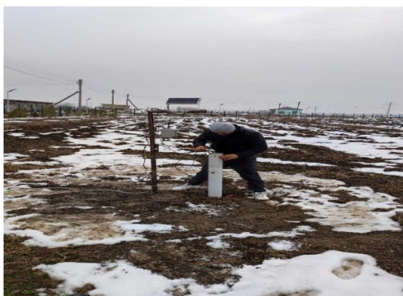
4.4-rasm. Kuzatuv quduqlarida yer osti suvlarning sathini o'lchash jarayoni
