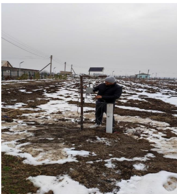
3.6-rasm. DIVER UIAPP V1.0 qurilmasi yordamida yer osti suvlari sathini o'lchash jarayoni
