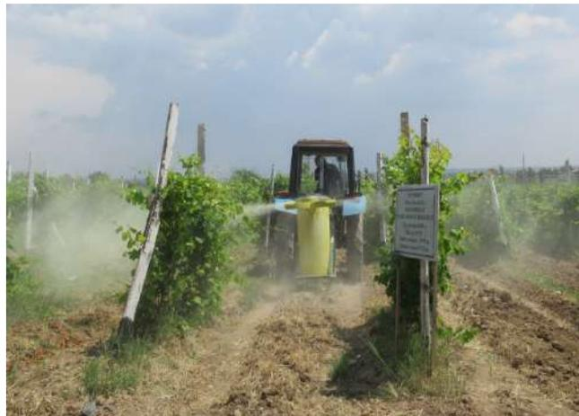
Рис.2 Опыливатель широкозахватный универсальный ОШУ-200 М. в агрегате с трактором Беларусь 82.1 в работе.
