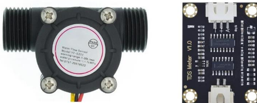
4-расм. Сув сифати ва оқим тезлигини аниқлаш учун қўлланиладиган TDC, TZT ва YF-C201/ YF-C168 датчиклар
