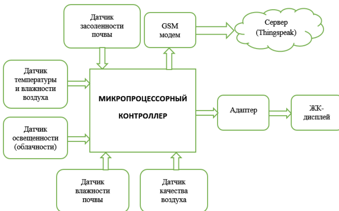
Рисунок 2. Блок-схема интеллектуальной системы мониторинга процесса полива на основе IoT
