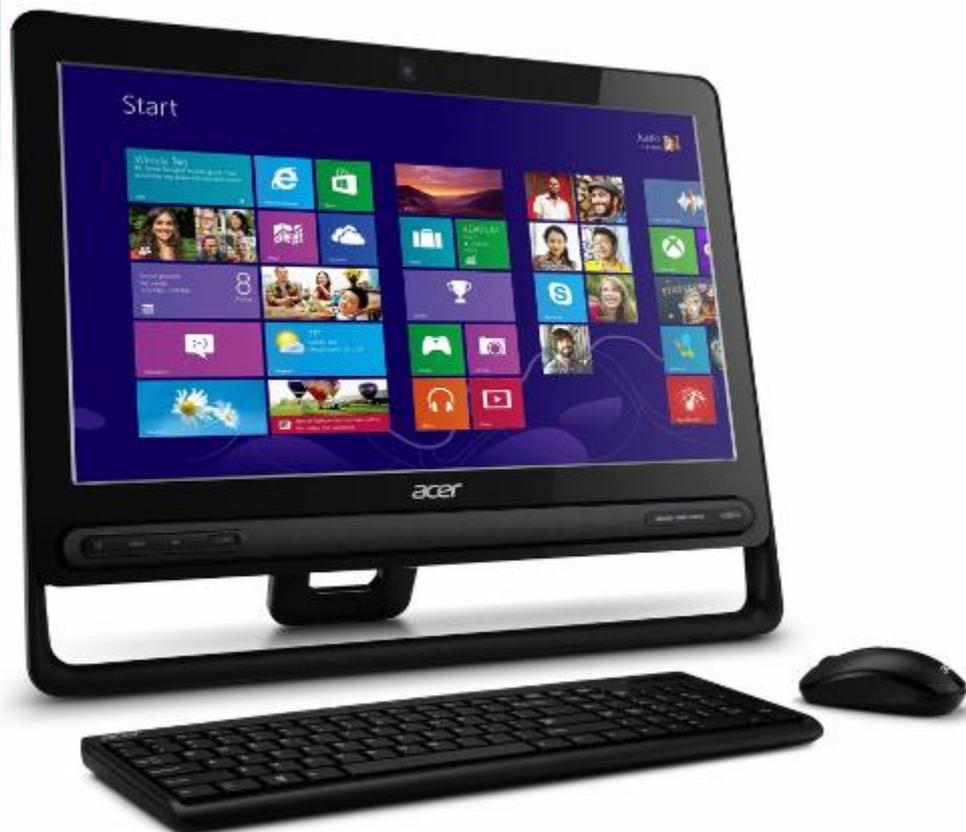
**Моноблок** (греч.  $\mu\omicron\nu\omicron\varsigma$  - один) – объединяет монитор и системный блок в одном корпусе, применяется для уменьшения занимаемой оборудовани<sup>ем</sup> площади и придания более эстетичного вида.
