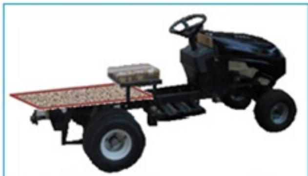
Рис.2. Миниэлектротрактор с двигателем ДК-908А
