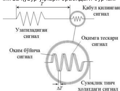
2-расм. Оқим йўналишига қарама-қарши ёки оқим йўналиши бўйича товуш тезлиги орасидаги фарқ.
