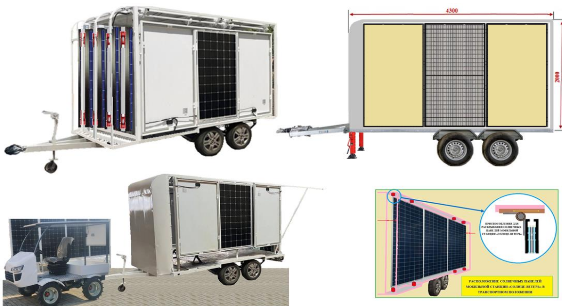
4-rasm. Qayta tiklanuvchi energiya manbalari asosida ishlovchi mobil elektr stantsiyalari yordamida zaryadlanadigan kombinatsiyalashgan elektr traktori
