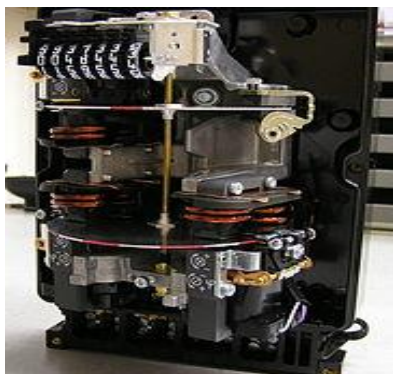
13.1-rasm. Induksion elektr hisoblagichning ochiq holda ko'rinishi
