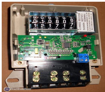
13.2-rasm. Zamonaviy elektr hisoblagichning ochiq holda ko'rinishi
