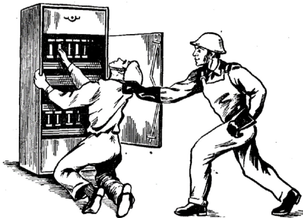
6.5-rasm. Kuchlanishi 1000 V gacha bo‘lgan elektr qurilmadan jabrlanuvchini bir qo‘l bilan tortib olish tartibi.
