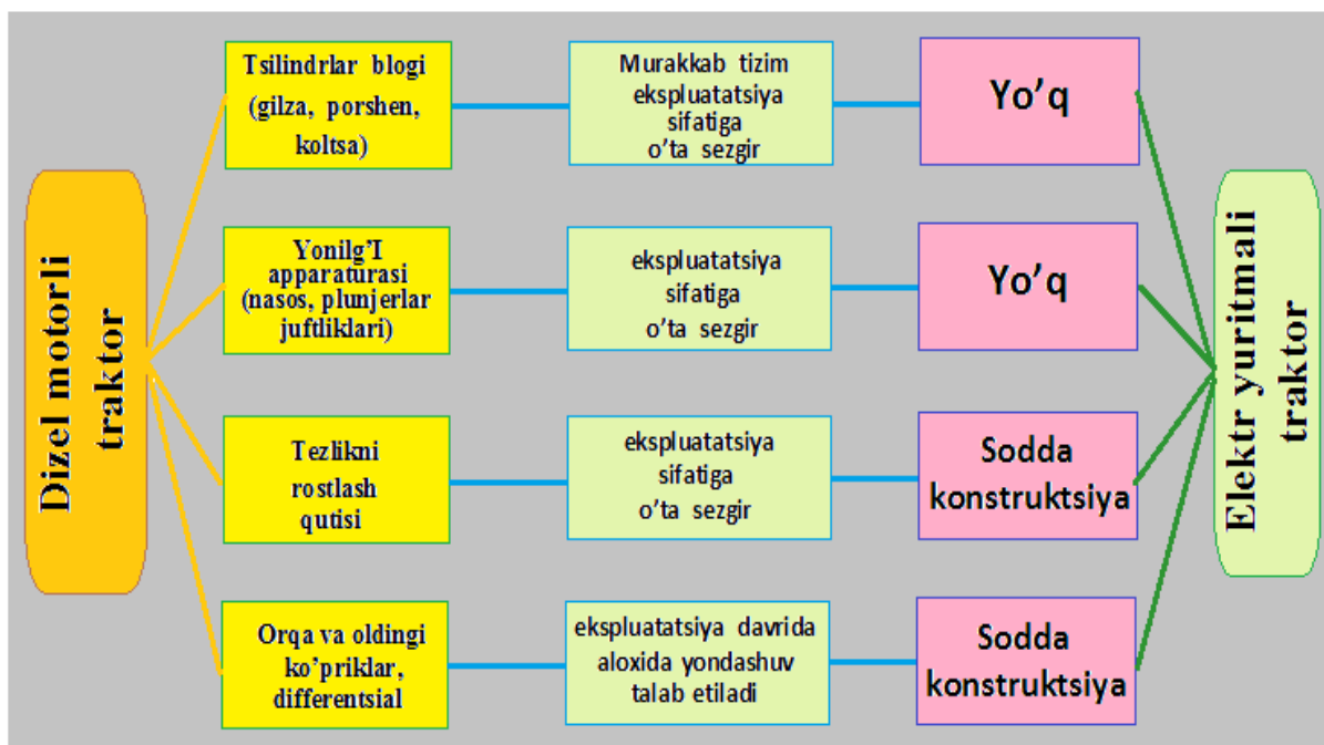
1.11-rasm. Dizel va elektr motorli traktorlarni asosiy qismlarini taqqoslash
