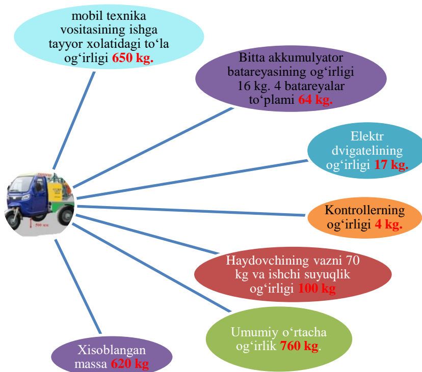
2.1-rasm. Elektr yuritmalı mobil texnika vositasiga tasir etuvchi kuchlar
